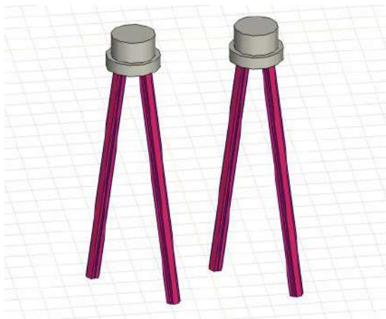
Figuur 4-1 Voorbeeld van 3D-model uit AxisVM van poerconstructie
