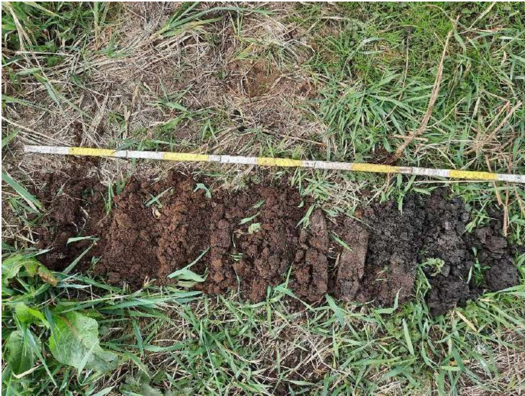
Afbeelding 5.2: Boring 0882 bij mast 088. V.l.n.r. uitgelegd.
