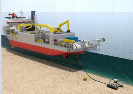
Abbildung 9: Beispiel ferngesteuertes Unterwasser-Raupenfahrzeug
