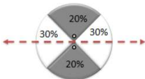
Figuur 4: Valrichtingsverdeling bij falen hoekmast met rechtdoorgaande lijn (0° is in lijnrichting) naar sector
