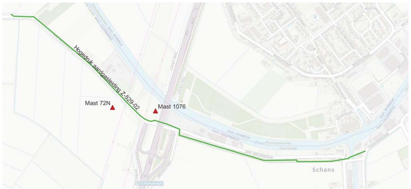
Figuur 11: Traject Leiding Z-529-02 (groene lijn) en betrokken hoogspanningsmasten nr 72N & 1076 (rode driehoek)
