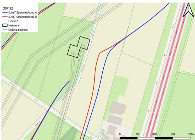
Figuur 24 0,4 μT-contour tijdelijke 150 kV OSP Mast 92
