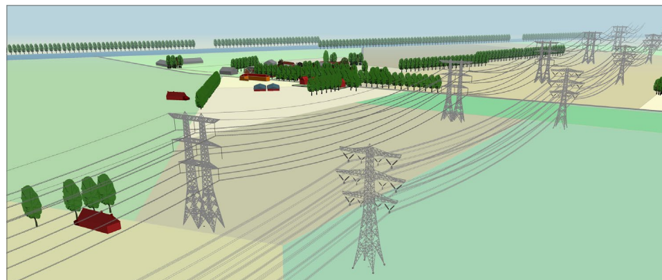
afb. 3 Bundelen met 3x380kV verbinding ten tussen Geertruidenberg en Tilburg links de bestaande 3x380kV verbinding, rechts de Moldau combi-verbinding
