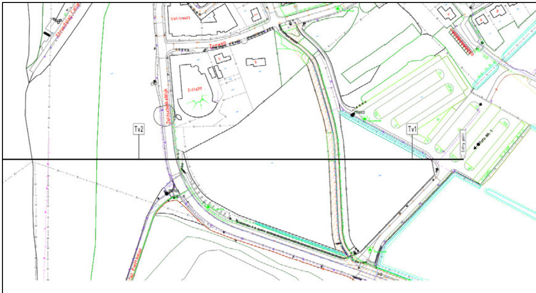
Figuur 2.3: Indicatie boortracé vanaf parkeerplaats naar zee (uitsnede uit boorplan)
