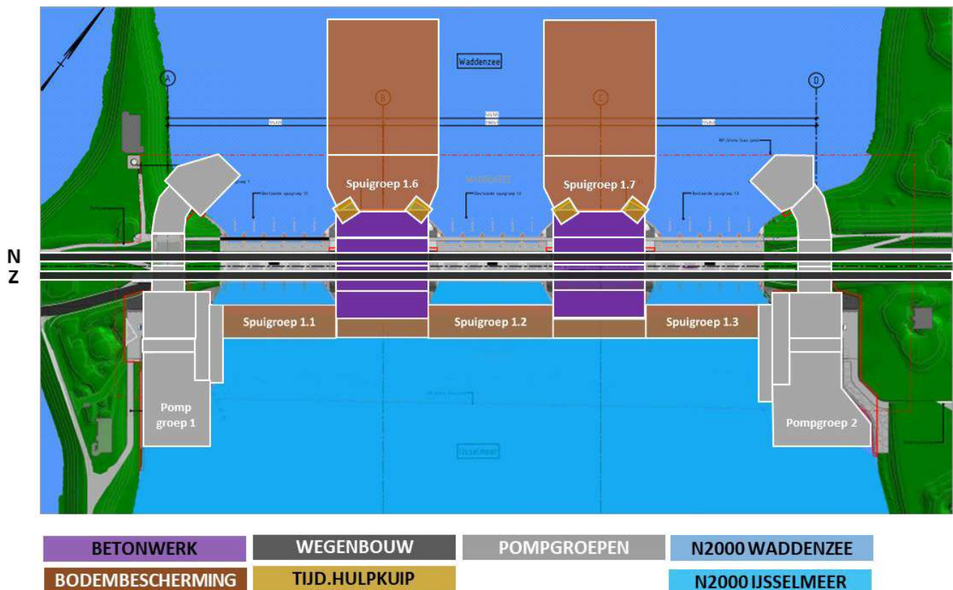
Figuur 2. Plangebied Spuicomplex Den Oever met nieuwe te bouwen spui- en pomp groepen. Spuigroepen 1.1 tot en met 1.3 zijn bestaand. Pompgroepen 1 en 2 en Spuigroepen 1.6 en 1.7 zijn nieuw.
