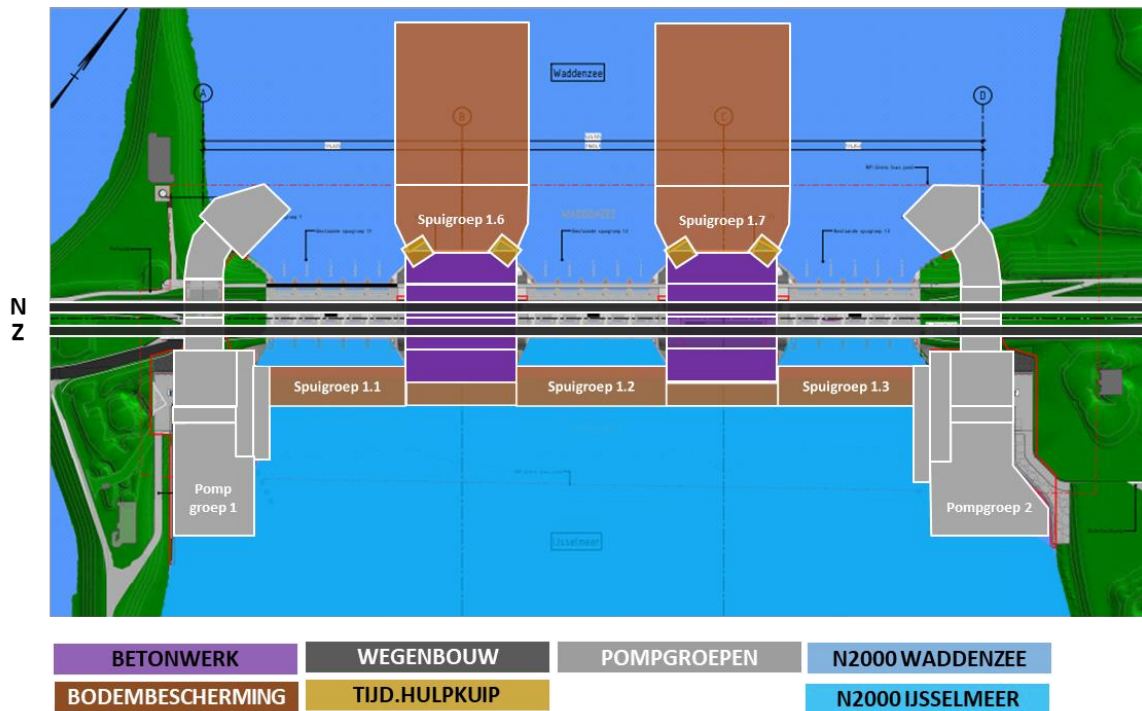
Abbeelding 2.1 Plangebied Spuicomplex Den Oever met nieuw te bouwen spui- en pompgroepen. Spuigroepen 1.1 tot en met 1.3 zijn bestaand. Spuigroepen 1.6 en 1.7 zijn nieuw
