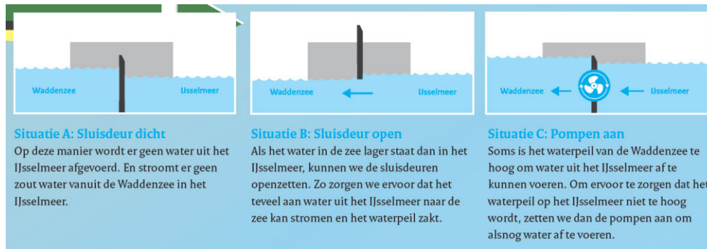
Figuur 9 De werking van spuisluizen en pompgemalen
