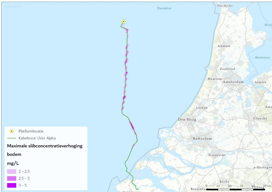
Figuur 2-2 Reikwijdte vertroebeling in de waterkolom (boven) en nabij de bodem (onder) voor Net op zee IJmuiden Ver Alpha.
