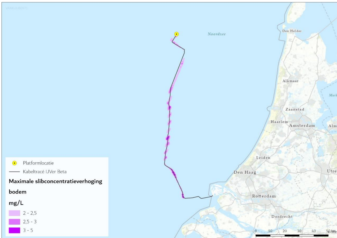
Figuur 2-4 Reikwijdte vertroebeling in de waterkolom (boven) en nabij de bodem (onder) voor Net op zee IJmuiden Ver Beta.
