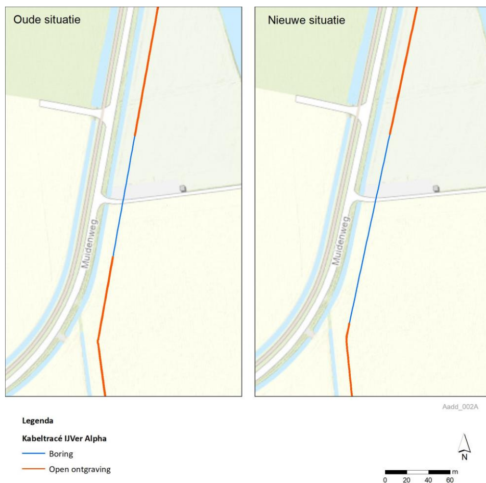
Figuur 1-2 Verlenging van de boring parallel aan de Muidenweg
