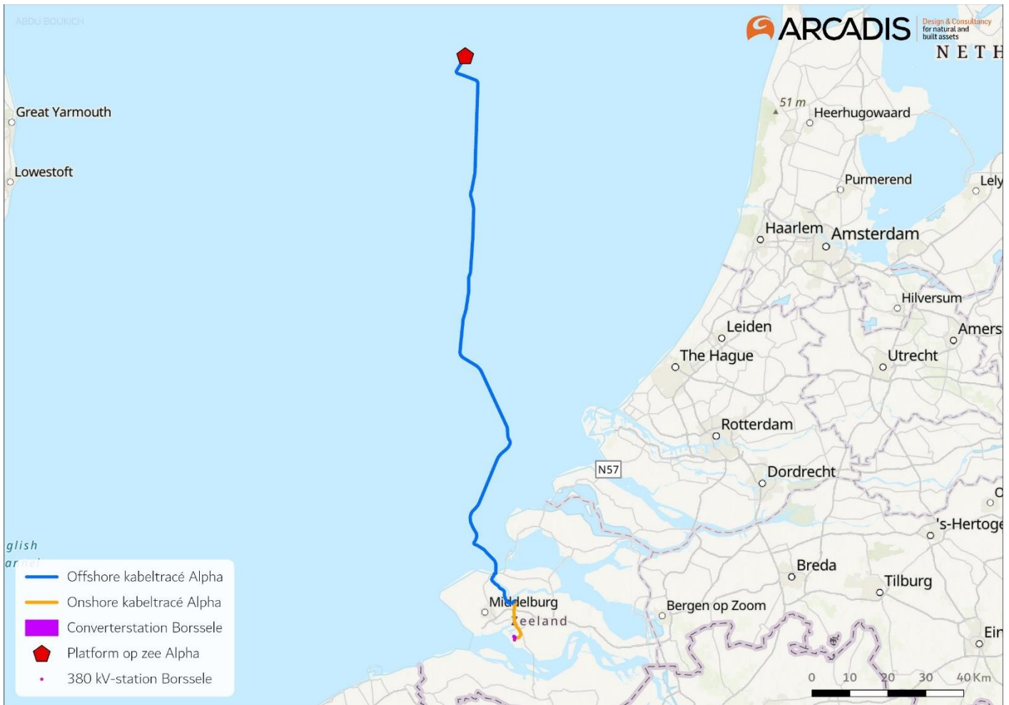
Figuur 1 Ligging kabeltracés, converterstation en platform
