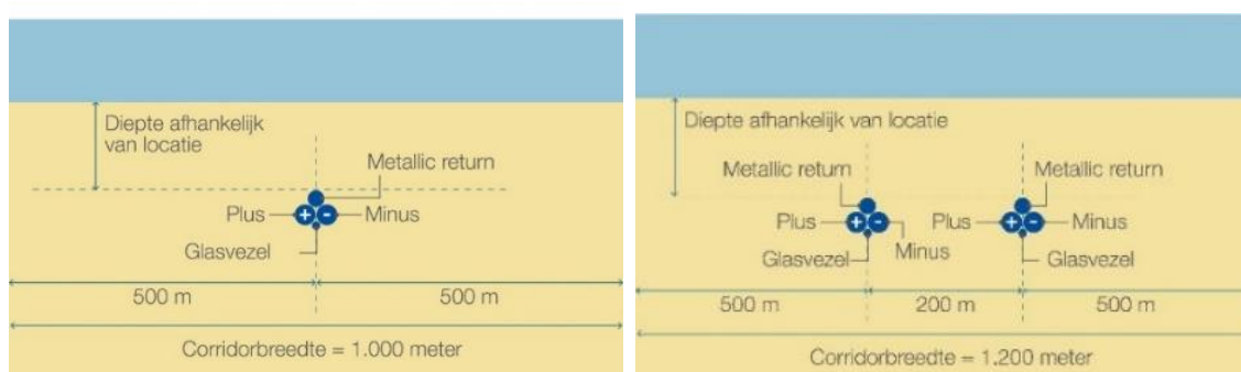
Figuur 2-3 Links; één kabeltracé zonder parallelligging (corridor 1.000 meter). Rechts; kabels voor IJmuiden Ver Alpha en Beta parallel (corridor 1.200 meter)
