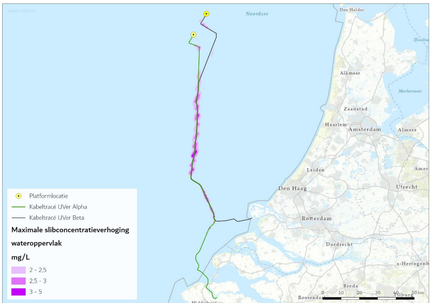
Figuur 2-5 Maximale reikwijdte vertroebeling aan het wateroppervlak voor Net op Zee IJmuiden Ver Alpha en Beta
