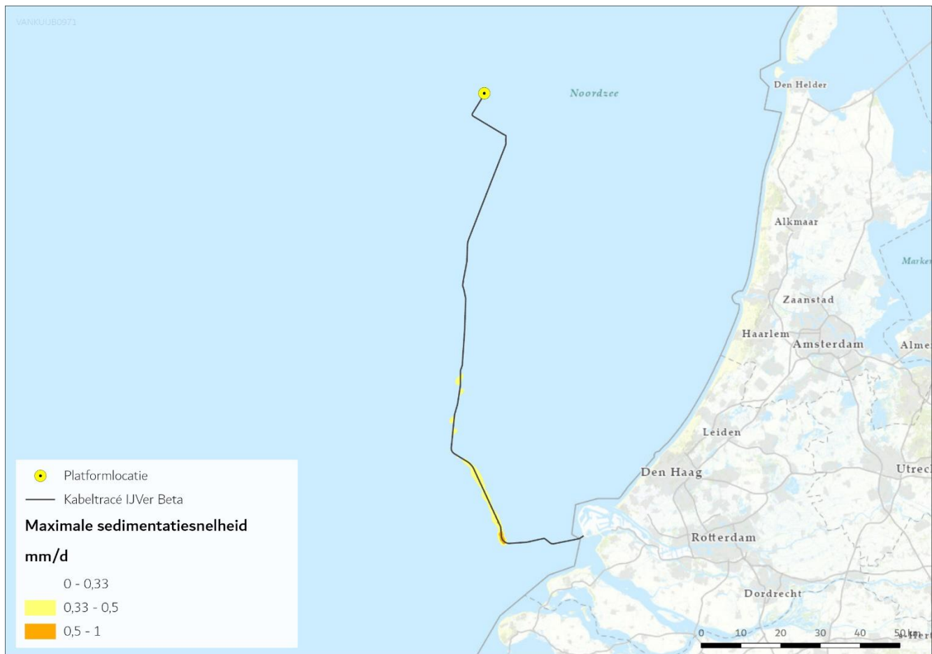
Figuur 2-8 Maximale reikwijdte sedimentatie voor Net op Zee IJmuiden Ver Beta
