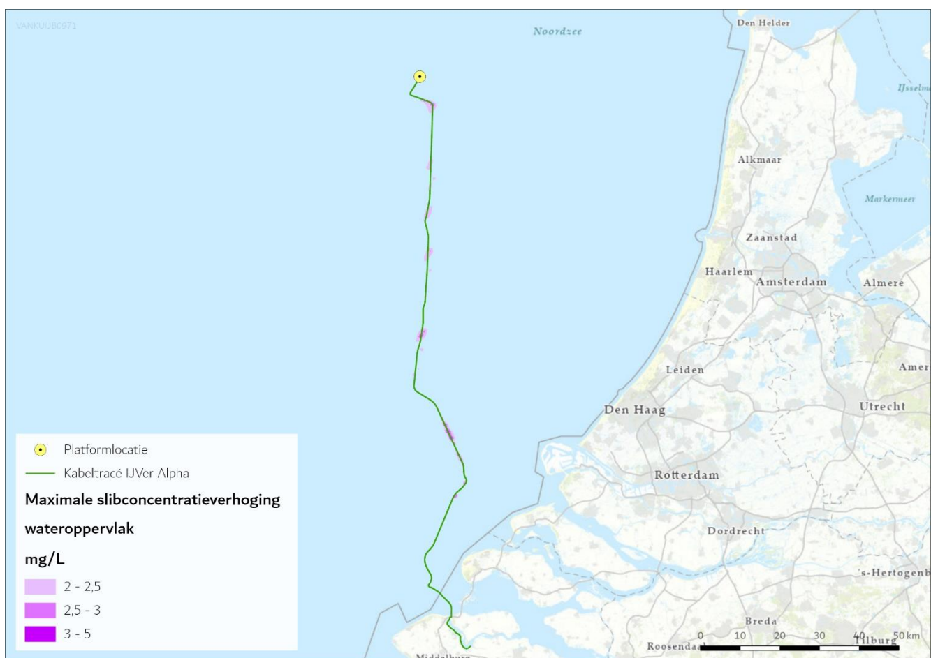
Figuur 2-1 Maximale reikwijdte vertroebeling aan het wateroppervlak voor Net op Zee IJmuiden Ver Alpha
