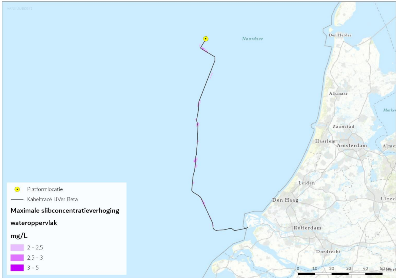
Figuur 2-3 Maximale reikwijdte vertroebeling aan het wateroppervlak voor Net op Zee IJmuiden Ver Beta
