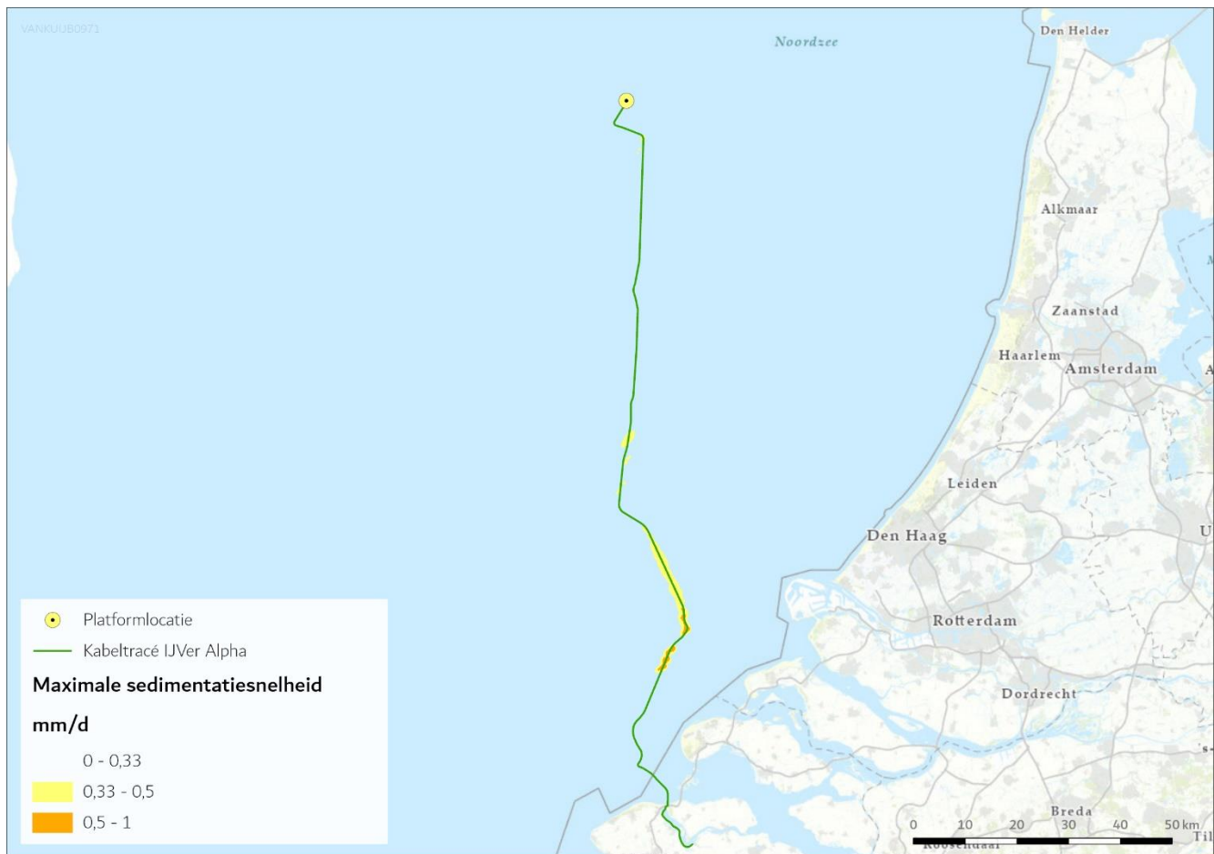
Figuur 2-7 Maximale reikwijdte sedimentatie voor Net op Zee IJmuiden Ver Alpha
