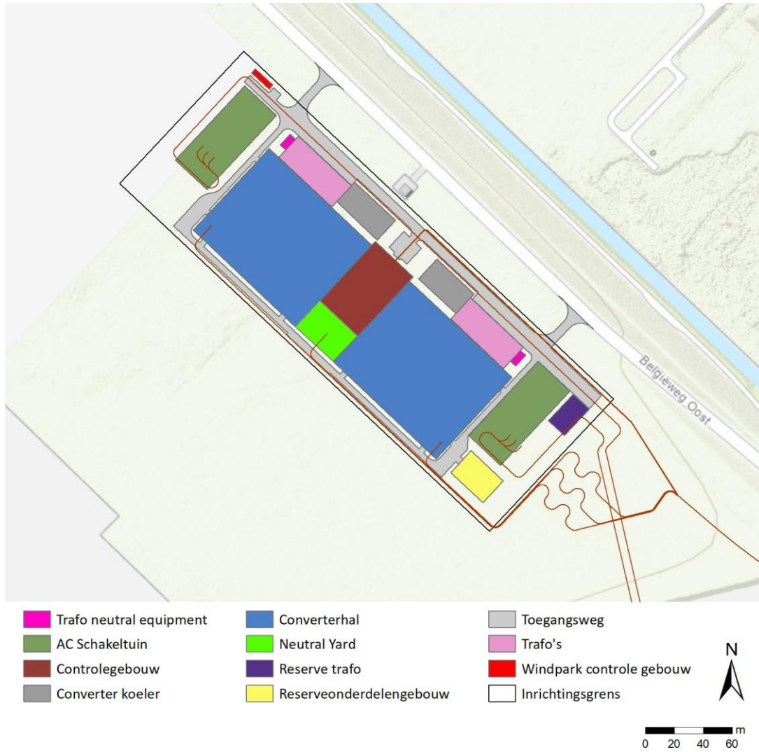
Figuur 0-2 Converterstation Alpha nieuwe lay-out
