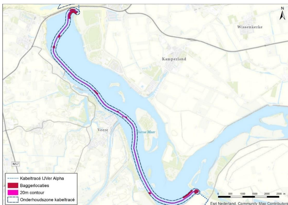
Figuur 3-10 Baggerlocaties in het Veerse Meer, op de ondiepe delen van het VKA-tracé
