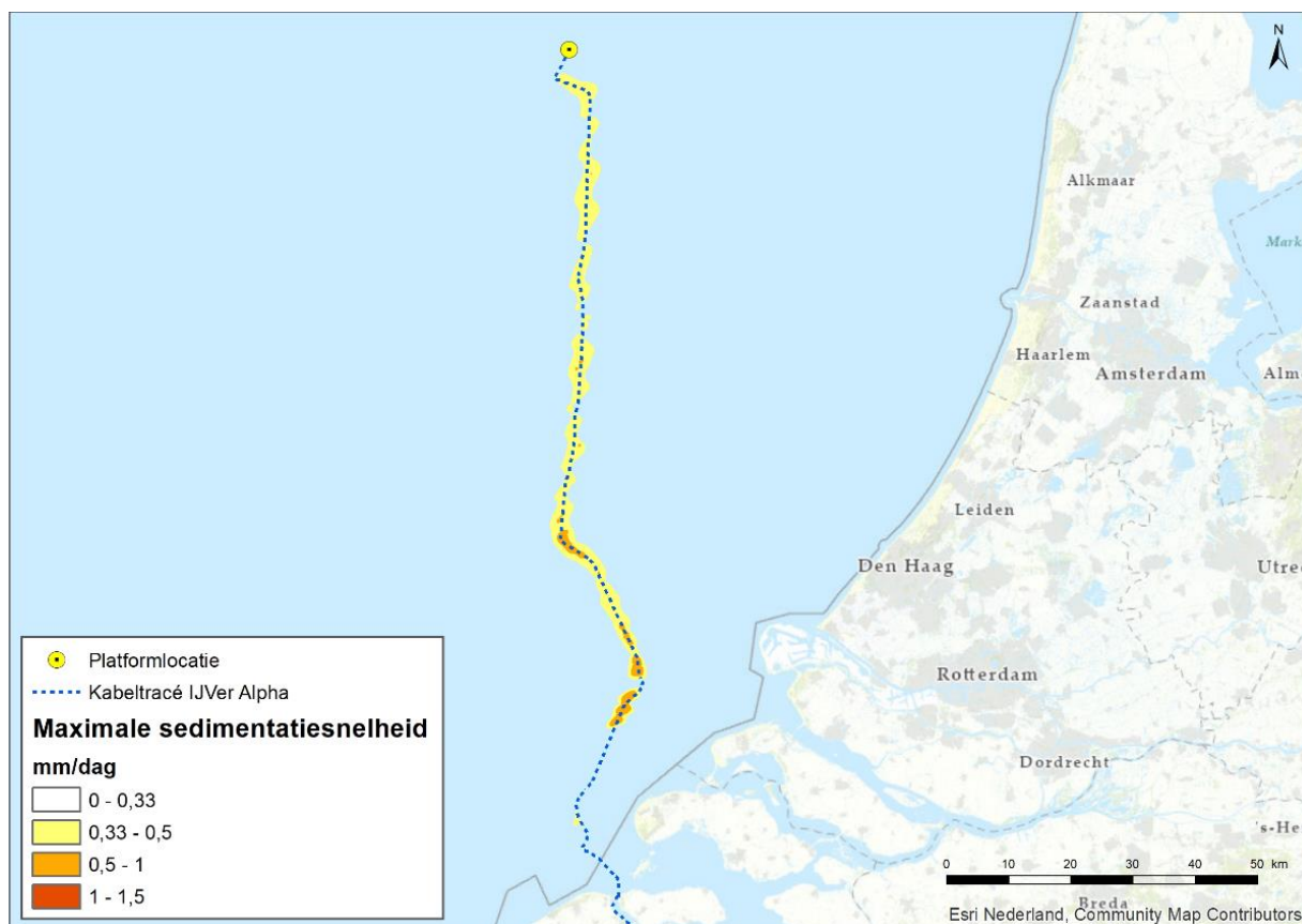
Figuur 4-3 Maximale sedimentatie snelheden (in mm/dag) die optreden door de werkzaamheden
