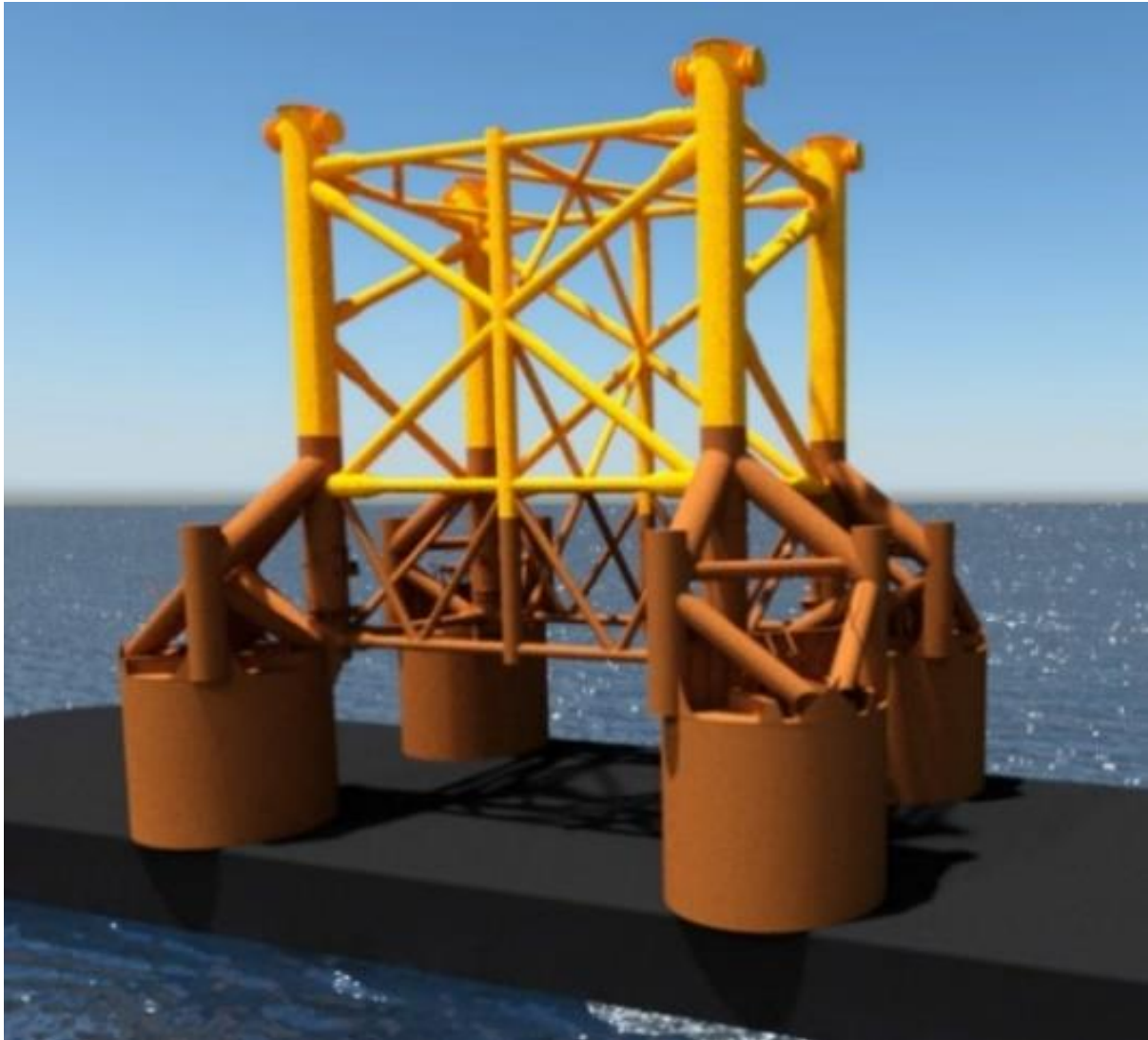
Figuur 2-6 Impressie van een jacket met suction buckets
