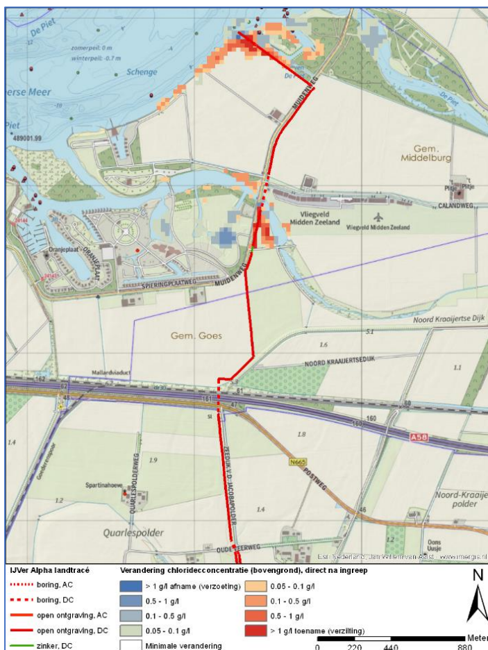
Figuur 5-17 Verandering zoutconcentratie van het bovenste grondwater (tussen maaiveld en NAP -2 m) – variant oost en west, noordelijk deel van het VKA-tracé op land
