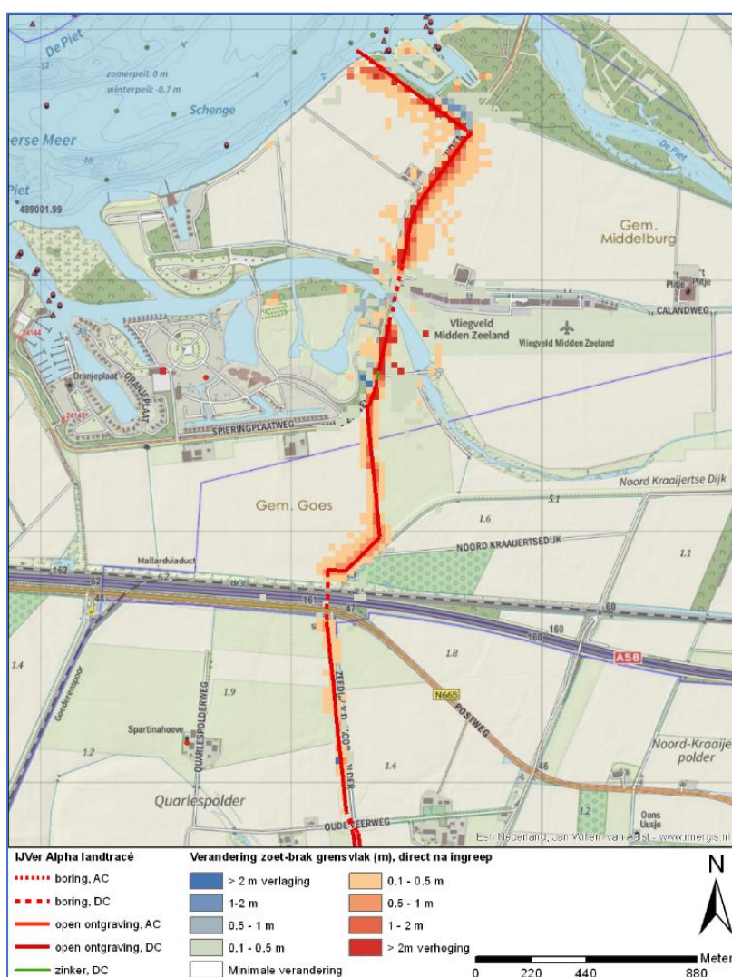
Figuur 5-7 Verschuiving zoet-brak grensvlak variant oost en west, noordelijk deel van het VKA-tracé op land
