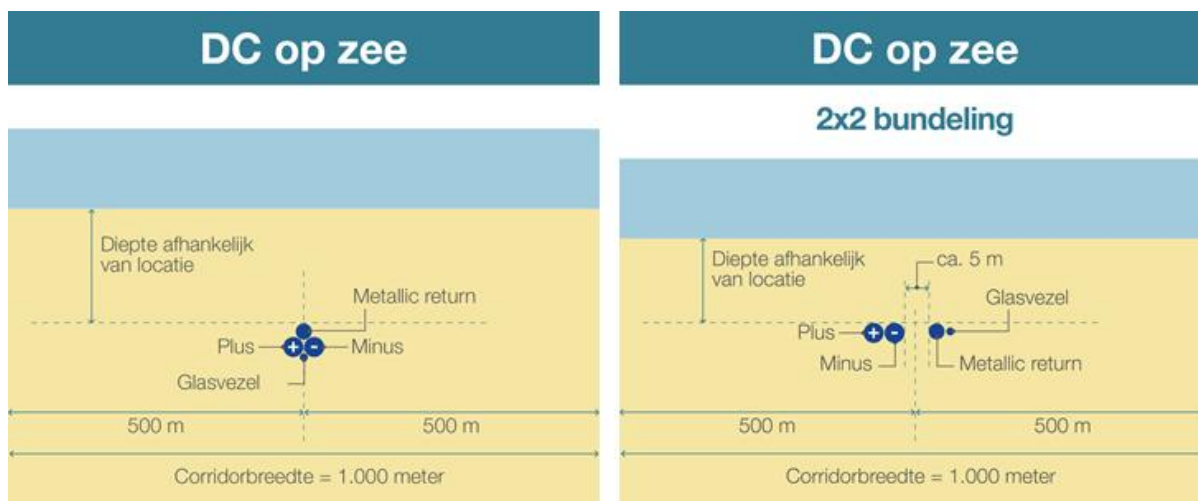
Figuur 3-11 (1x4)-kabelconfiguratie op zee (links) en (2x2)-kabelconfiguratie op zee (rechts)
