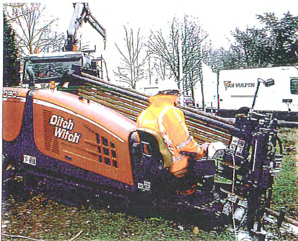
Afbeelding: 16 tons boor-rig Van Vulpes
