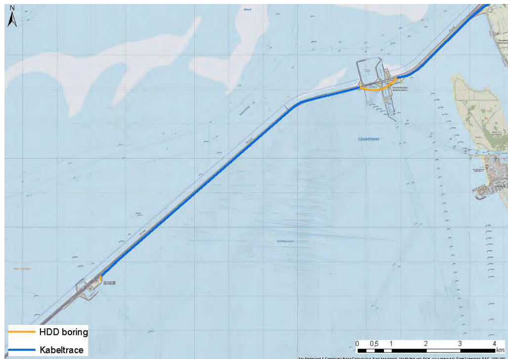
Figuur 1 Overzichtstekening Kabeltracé windpark Fryslân
