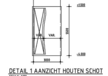
DETAIL 1 AANZICHT HOUTEN SCHOT SCHAAFL 1:100
