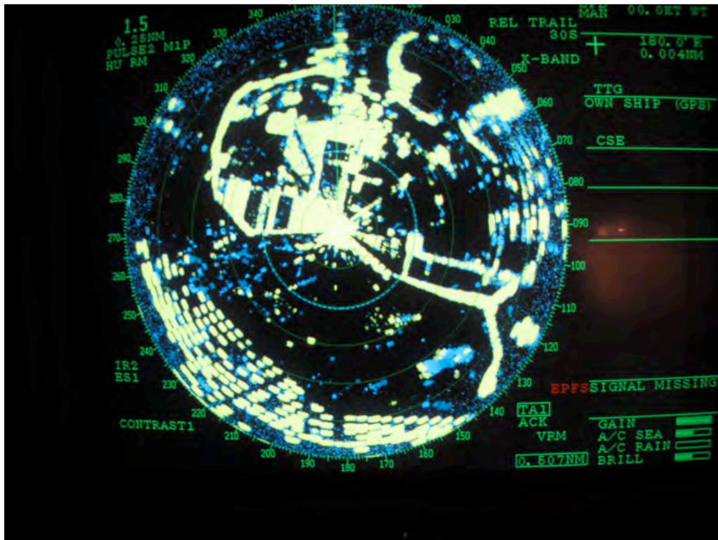
Figuur 3.2 Typische steltloper vliegbewegingen op het radarscherm tijdens het verlaten van de hvp's. In geel zijn de kustlijn en bebouwing op Tholen goed zichtbaar. Aan de onderkant van het beeld is een rij tonnen op water van de mosselvisserij te zien. Een groep vogels is rechtsonder op het beeld goed zichtbaar hoe ze boven het water van de kust van Tholen wegvliegen. Actuele positie van de vogelbeweging is met geel gemarkeerd, de net afgelegde route met lichtblauw.
