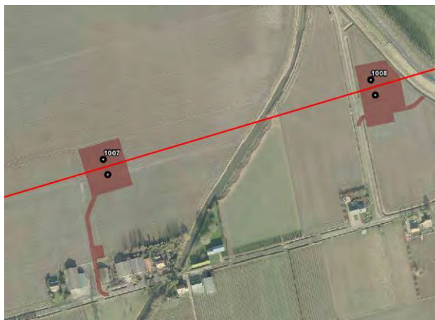
Figuur 2.4 Voorbeeld van het tijdelijk extra ruimtebeslag voor bouwterrein en toegangswegen (bron: Mastboek VKA 2.0).
