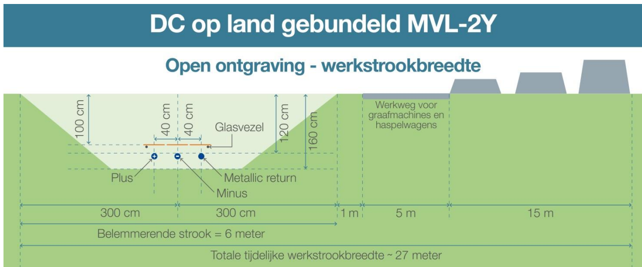
Figuur 5. Open ontgraving met werkstrookbreedte.
