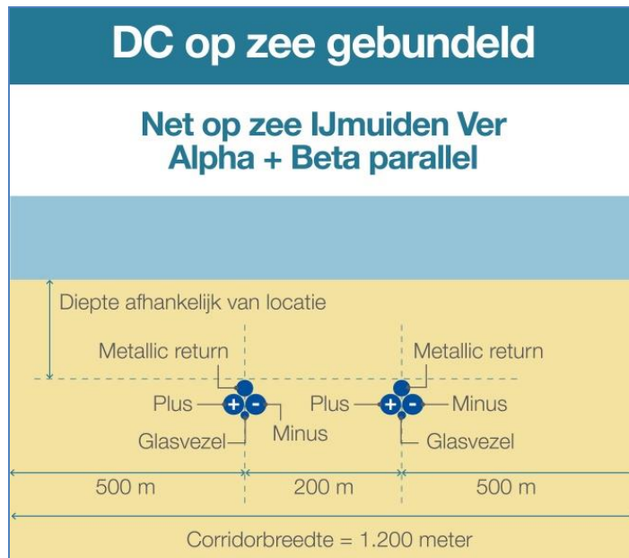
Afbeelding 3. Breedte kabeltracés op zee gebundelde ligging met twee parallelle kabeltracés (Alpha en Beta naast elkaar; bron: TenneT)
