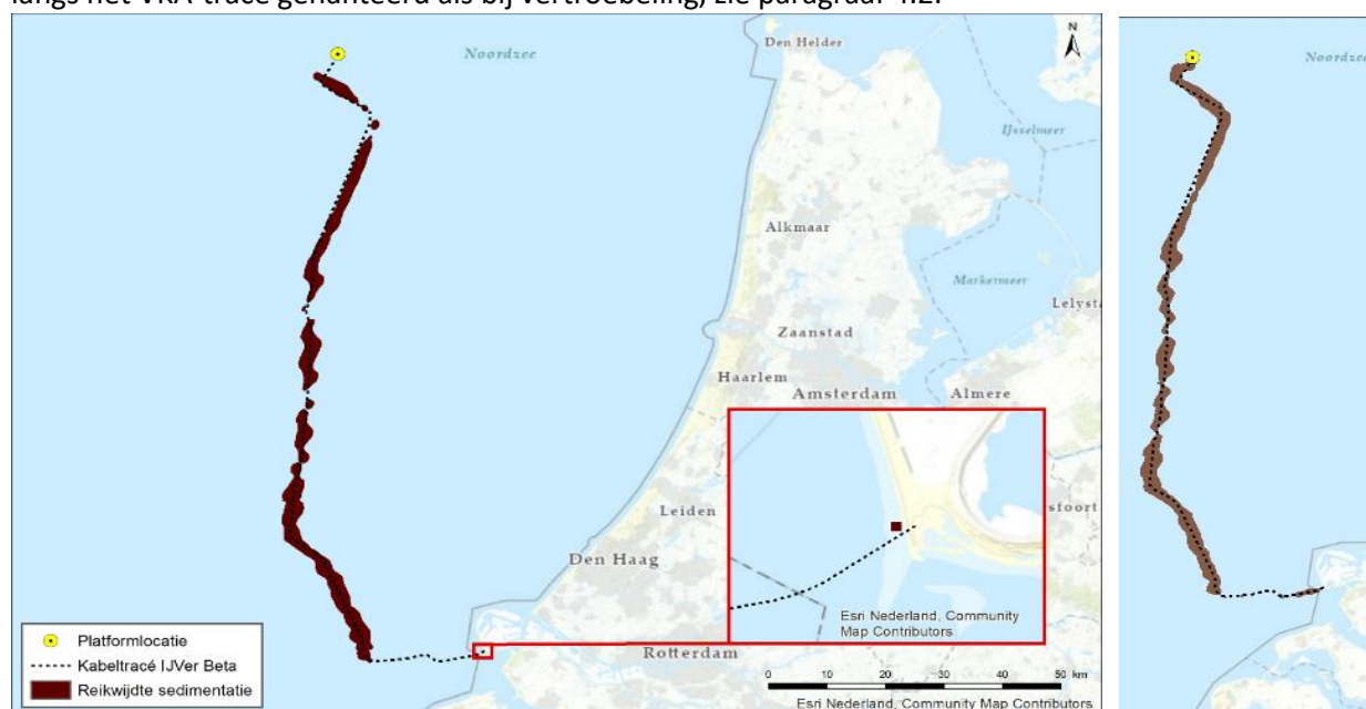
Figuur 29 geeft voor beide kabelconfiguraties het gebied weer waar per dag sedimentatie van meer dan 0,33 mm/dag optreedt na de werkzaamheden. Dit is de maximale sedimentatie snelheid die de gevoeligste soort ( Mya arenaria ) nog tolereert (Bijkerk, 1988). In het figuur is te zien dat de sedimentatiesnelheden boven de 0,33 mm/dag rondom het tracé met name in het gedeelte vanaf 20 km uit de kust worden bereikt. Hierbinnen ligt de sedimentatiesnelheid rondom het tracé tussen de 0 – 0,35 mm/dag (niet weergegeven in het figuur). Bij de (1x4)-kabelconfiguratie is alleen bij de
