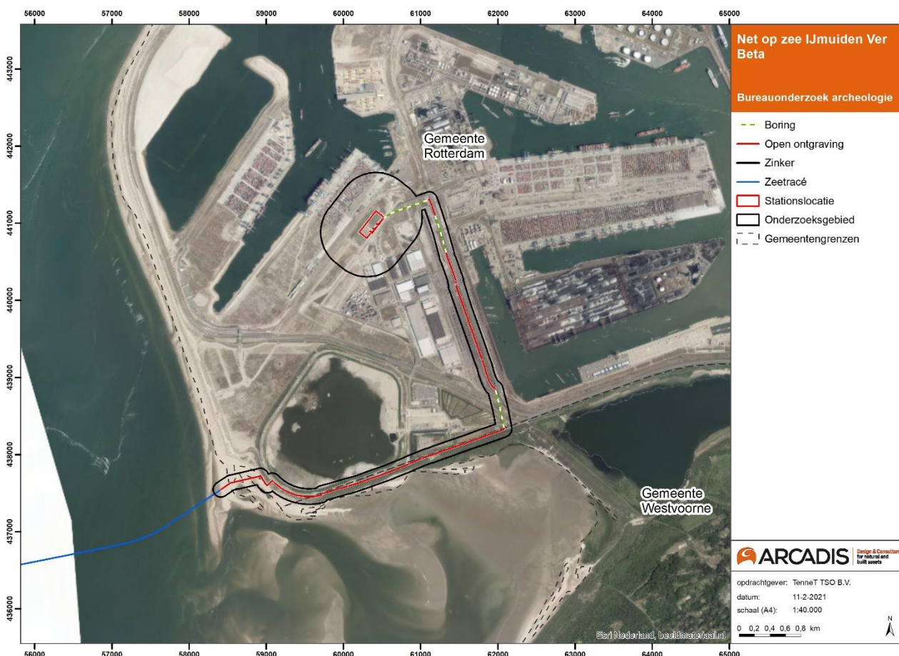
Figuur 1. Plangebied met daarop de aanlanding en de kabels van IJmuiden Ver Bèta op land.
