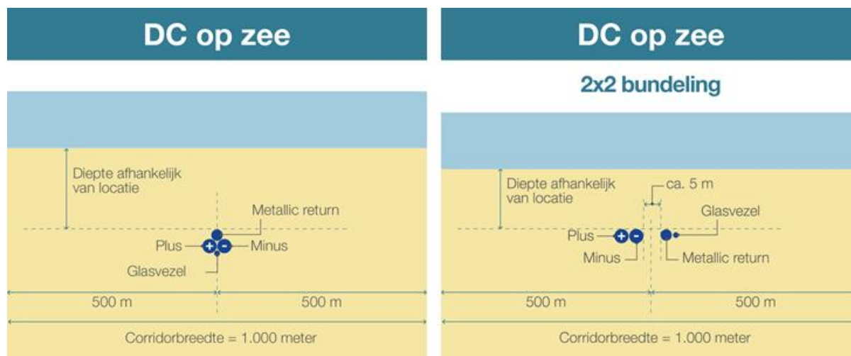
Figuur 14 (1x4)-kabelconfiguratie op zee (links) en (2x2)-kabelconfiguratie op zee (rechts)
