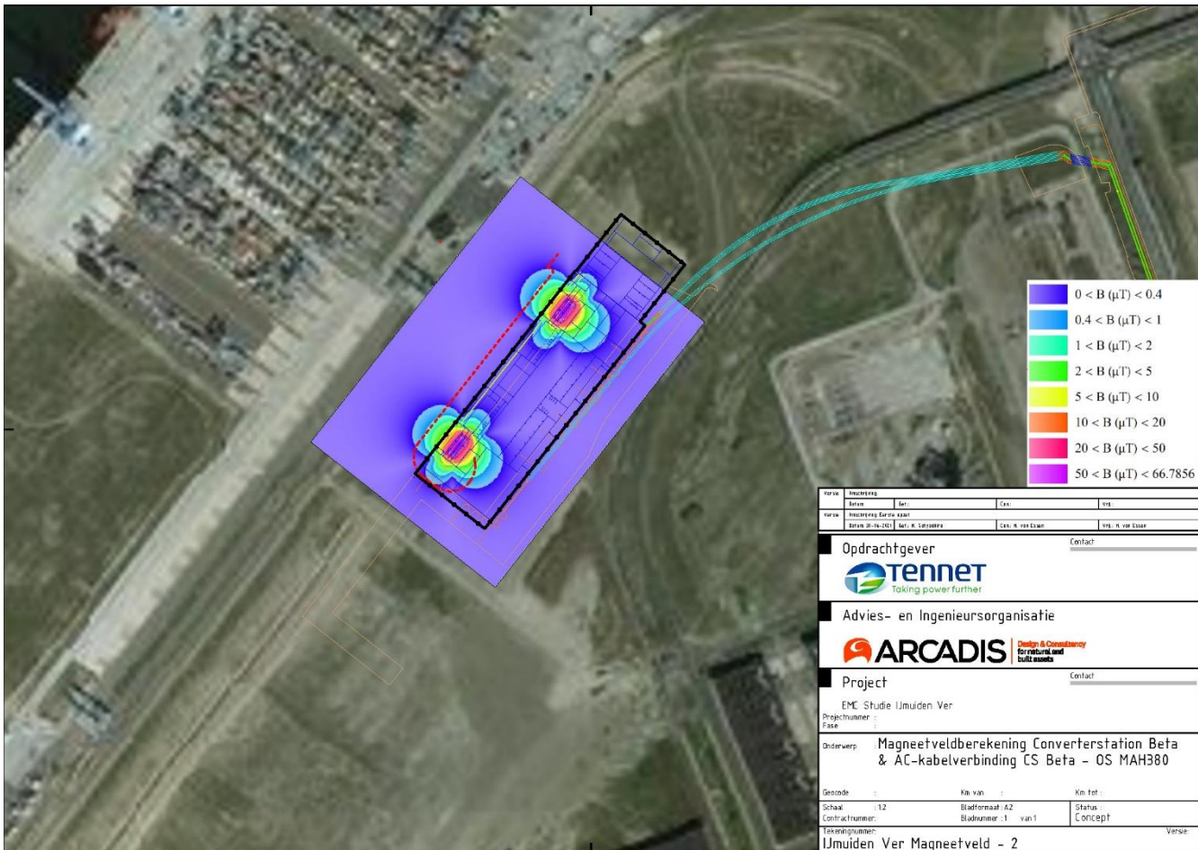
Figuur 5: Magneetveldzone in converterstation Beta en van AC-kabelverbinding converterstation Beta - 380kV-station Maasvlakte-Amaliahaven
