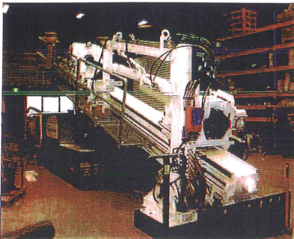
Afbeelding: 50 tons boor-rig Van Vulpen
