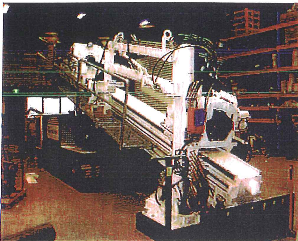
Afbeelding: 50 tons boor-rig Van Vulpen
