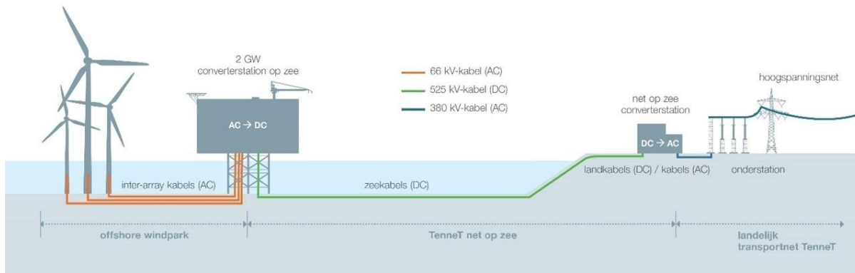
Figuur 0.4 Onderdelen project Net op zee IJmuiden Ver Beta loopt van het platform op zee tot de aansluiting op het landelijk hoogspanningsnet
