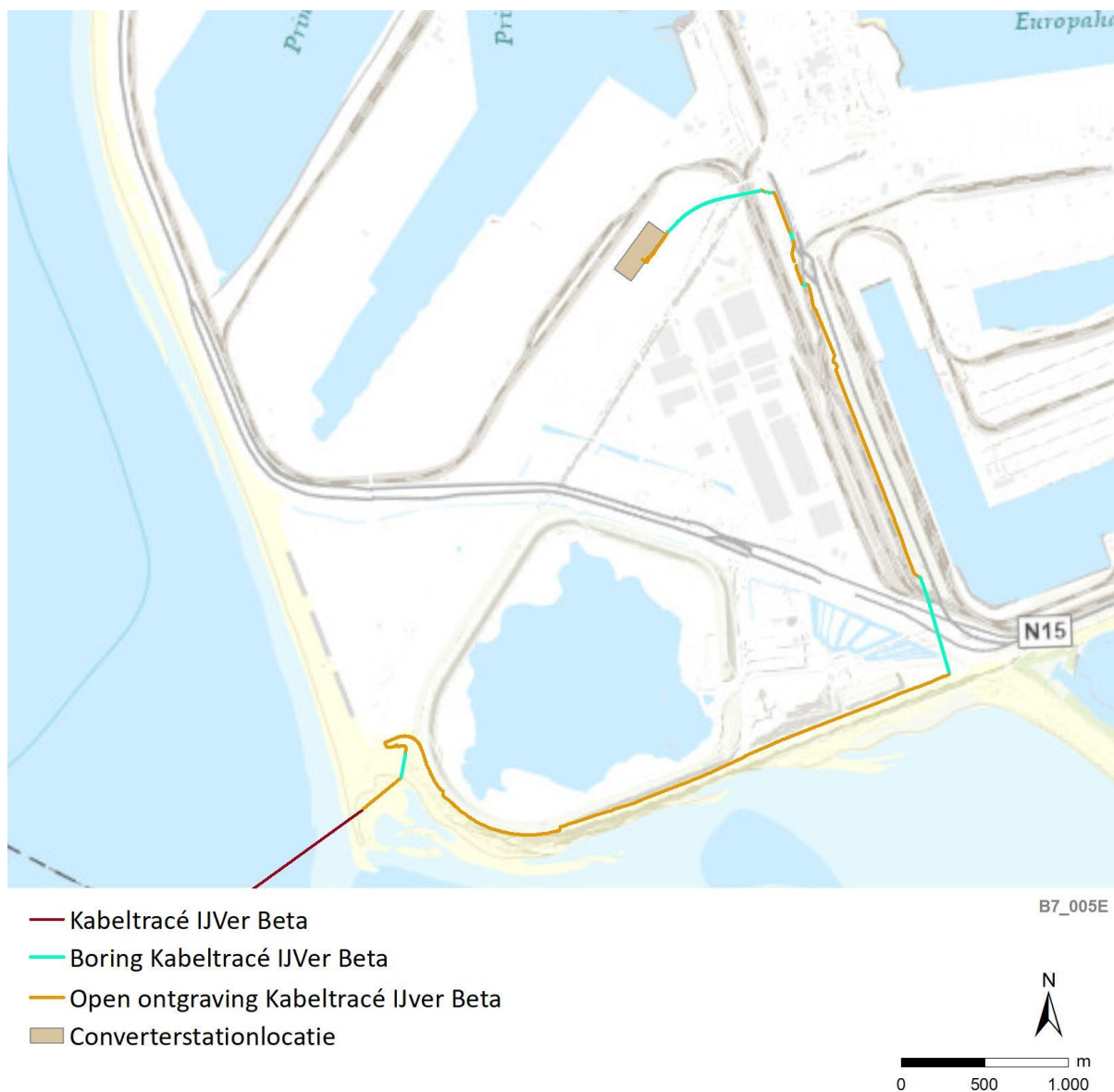
Figuur 0.9 VKA-tracé op land en de locatie van het converterstation
