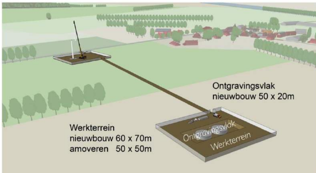
Figuur 7 Weergave werkterrein met indicatieve maatvoering.
