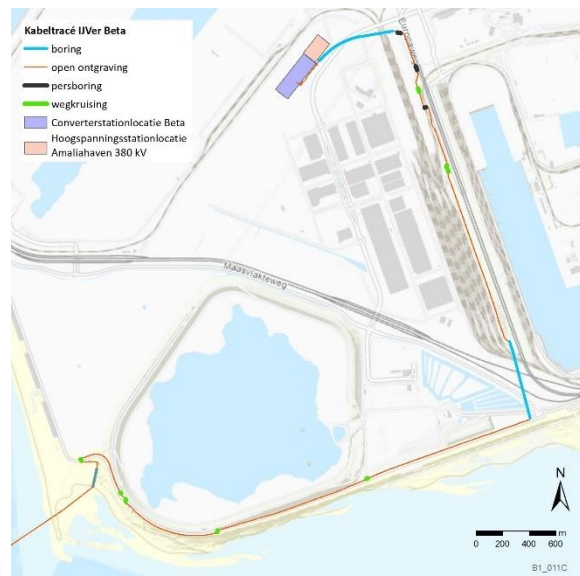
Figuur 3: tracé en locatie converterstation Net op zee IJmuiden Ver Beta op de Maasvlakte
