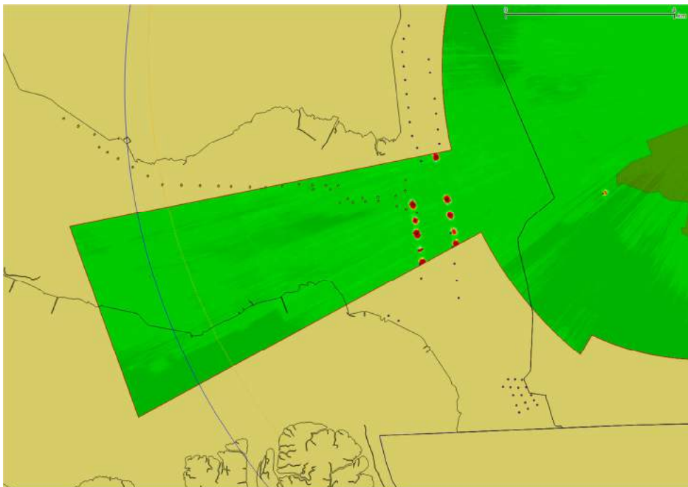
Figuur 14 Detectiekans van het MASS primaire verkeersleidingsradarnetwerk op 300 voet boven en in de nabijheid van het hoogspanningstracé nadat deze is gerealiseerd. De pylonen van het hoogspanningstracé zijn aangegeven met gele stippen.
