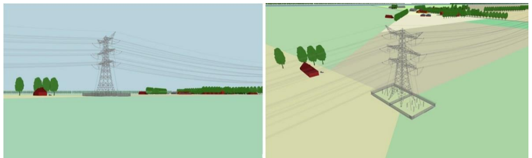
Figuur 4.11 Opstijgpunt 150 kV
