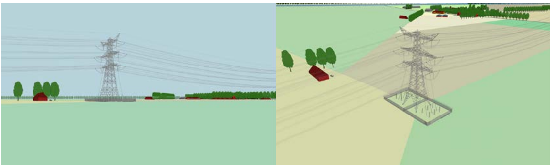
Figuur 3.5 Opstijpunt van de 150 kV-verbinding
