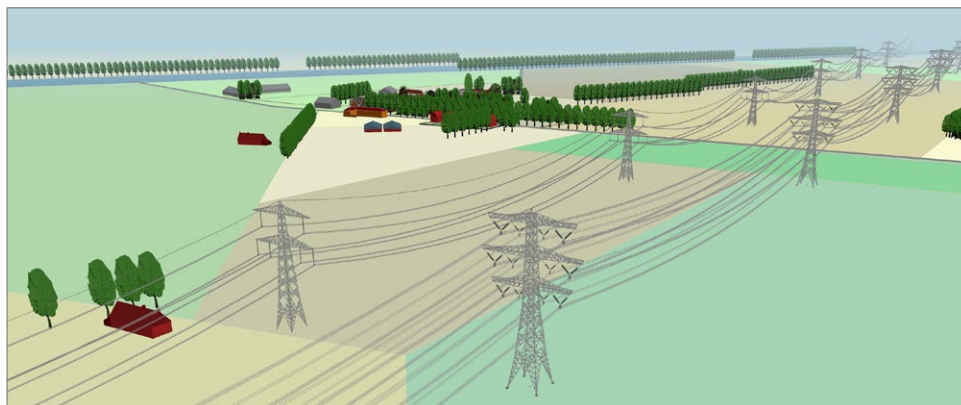
afb. 2 Bundelen met 2x380kV verbinding ten tussen Rilland en Geertruidenberg links de bestaande 2x380kV verbinding, rechts de Moldau combi-verbinding
