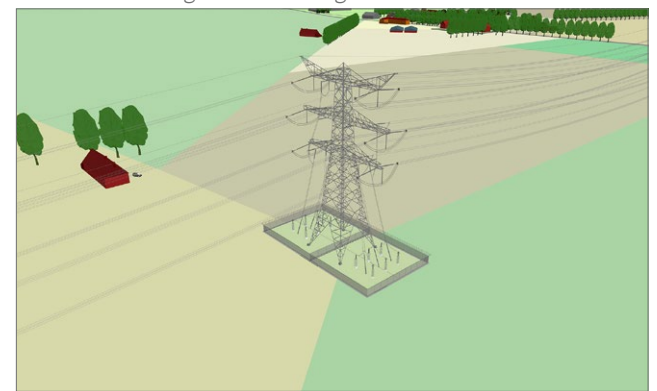
fig. 12 c 150kV opstijpunt: overgang van solo naar combi verbinding door inlusing van een 150kV kabel.
