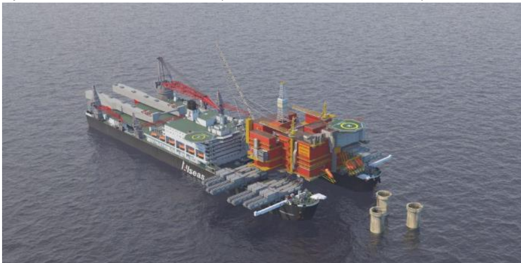
Figuur 1-4 Bovenbouw van onderen optillen m.b.v. een catamaranschip (hier: "Pioneering Spirit")
