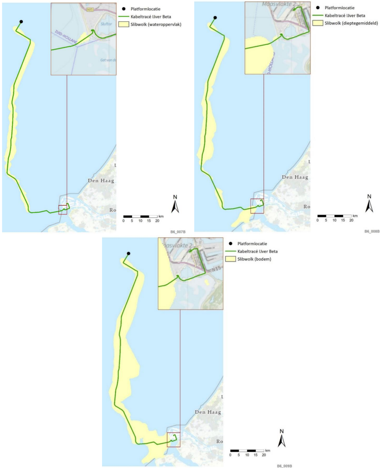
Figuur 4-42 Maximale omvang slibpluim van boven de 2 mg/l gedurende de gehele simulatieperiode voor wateroppervlak (linksboven), dieptegemiddeld (rechtsboven), en bodem (onder) voor de (1x4)-kabelconfiguratie
