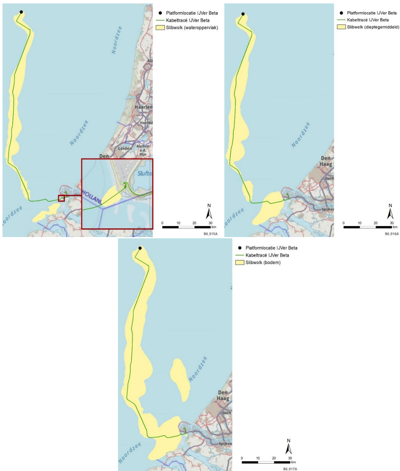
Figuur 4-43 Maximale omvang slibpluim van boven de 2 mg/l gedurende de gehele simulatieperiode voor wateroppervlak (linksboven), dieptegemiddeld (rechtsboven), en bodem (onder) voor de (2x2)-kabelconfiguratie
