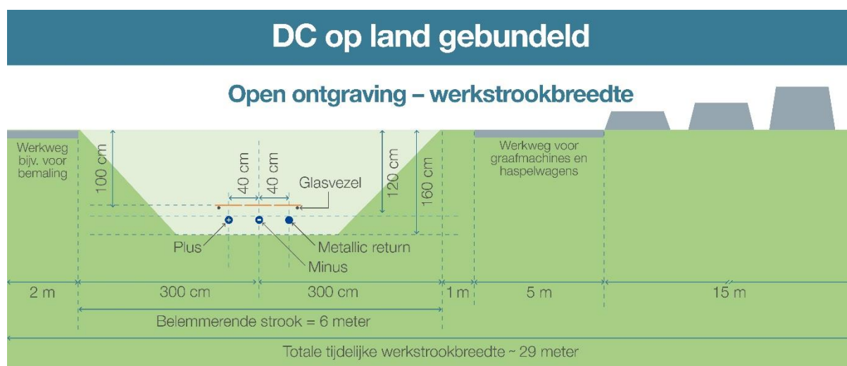
Figuur 1-16 Ruimtebeslag en werkstrookbreedte bij open ontgraving gebundelde ligging
