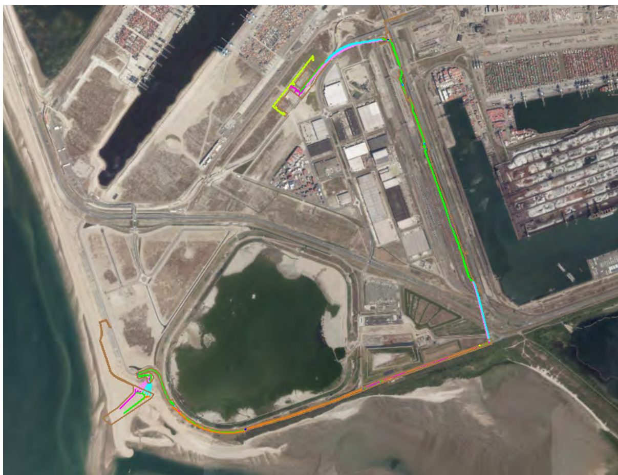
Figuur 1.1: Bovenaanzicht kabeltracé langs de Slufterdam
