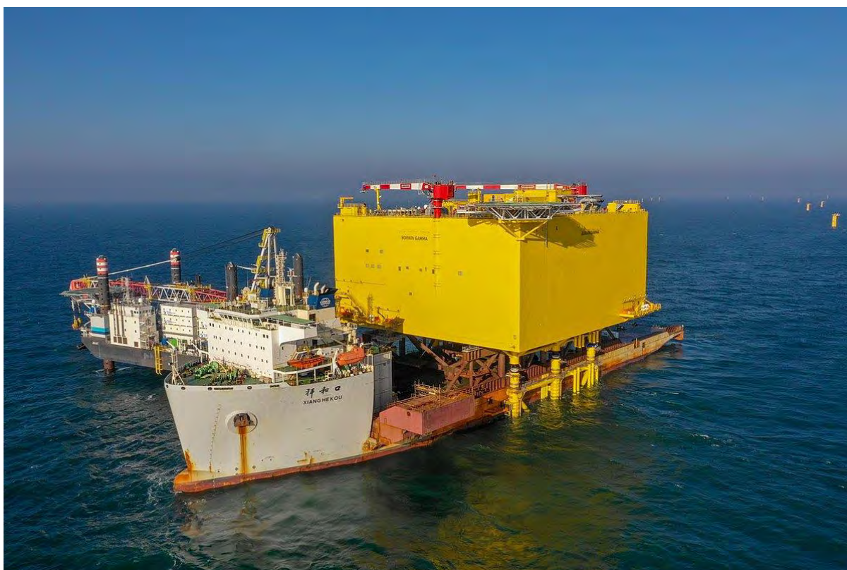
Figuur 3.5 Impressie drijvende installatietechniek
