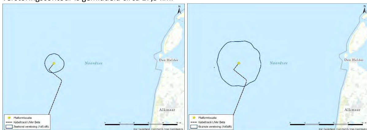
Figuur 21 Reikwijdte van onderwaterverstoring als gevolg van impuls-onderwatergeluid voor het heien van de fundering van het platform Net op zee IJmuiden, voor zeehonden (links) en bruinvissen (rechts)
