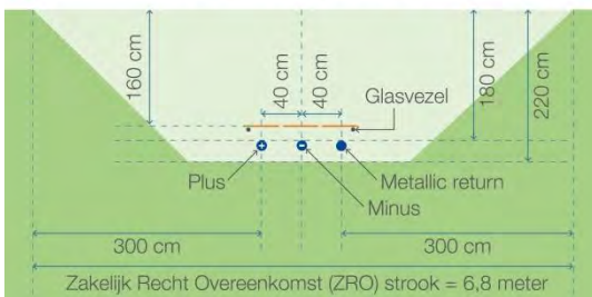
Figuur 7: Kabelconfiguratie open ontgraving IJmuiden Ver Alpha
