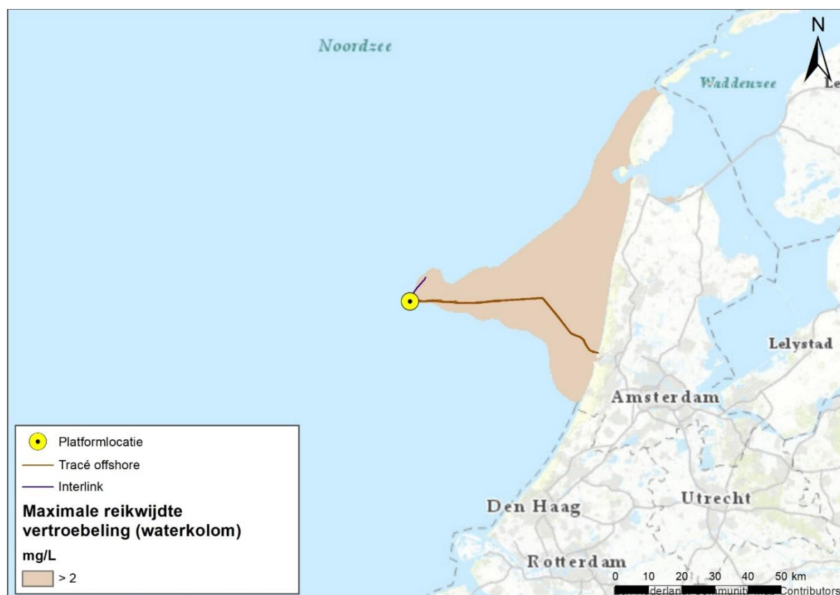
Figuur 119: Gebied tot waar de dieptegemiddelde slibwolk (> 2 mg/l) ten gevolge van de werkzaamheden rijkt (Arcadis, 2018).
