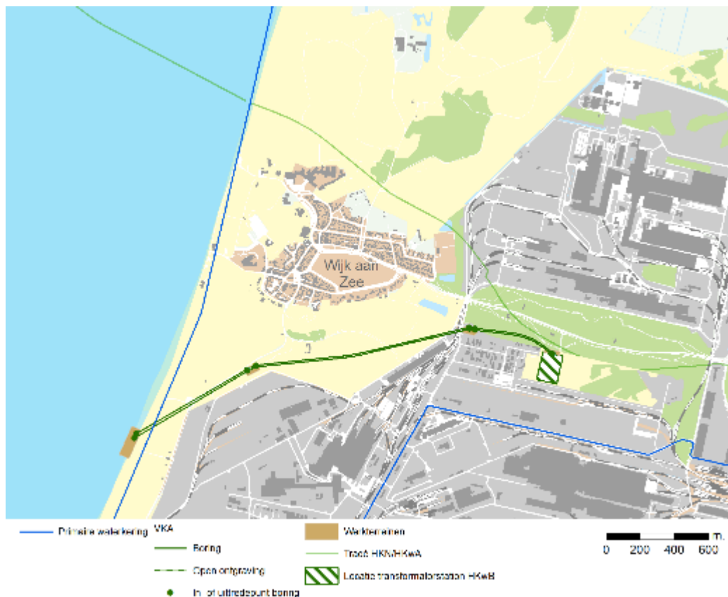
Figuur 5.11: Kabeltracé op land en primaire waterkering
