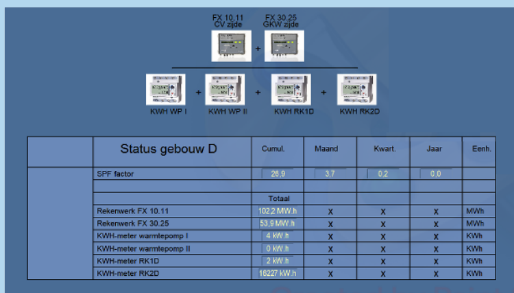
Figuur 2 SPF berekening als opgenomen in een gebouwbeheersysteem
