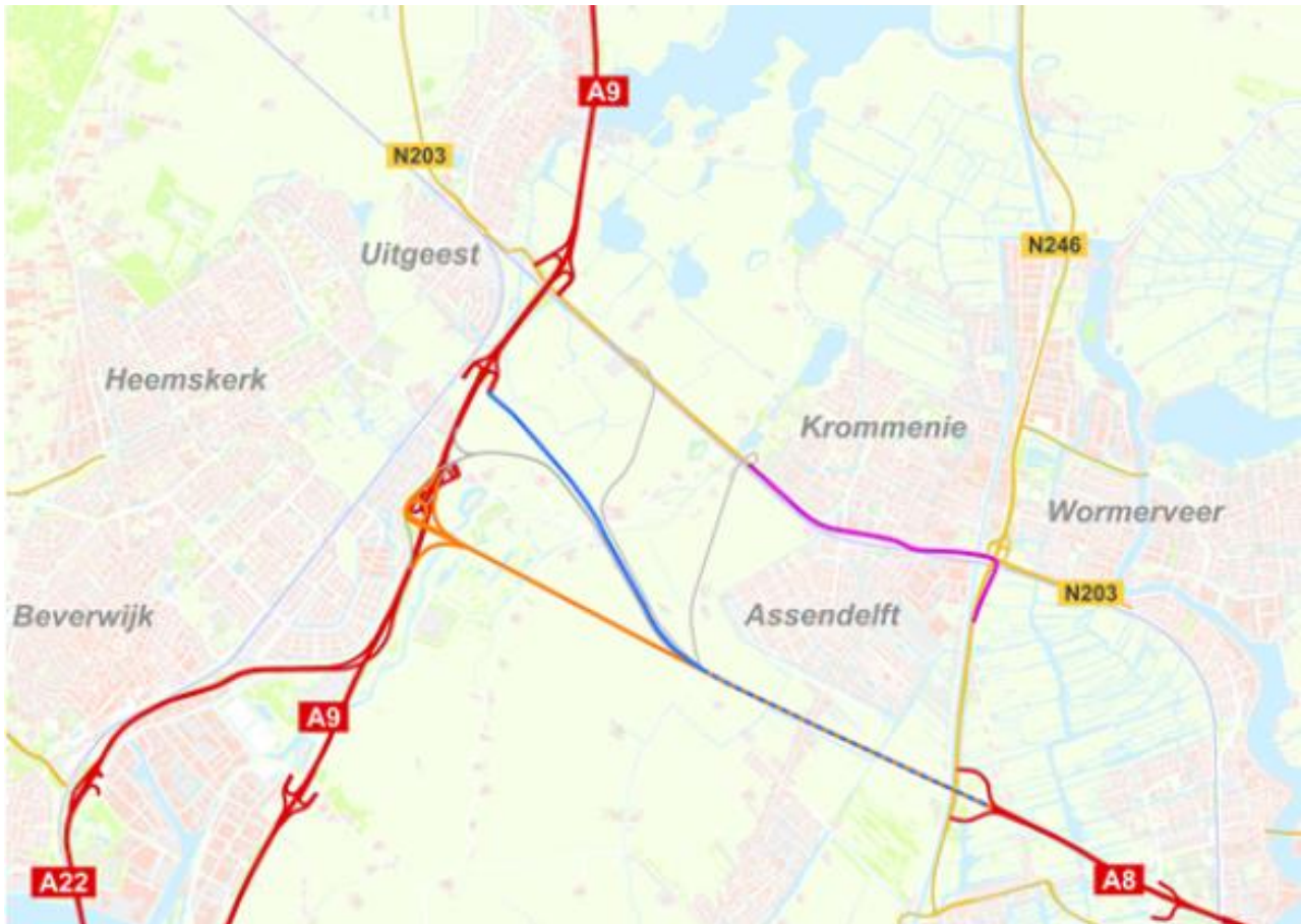
Figuur 10-25 Naar het Nul-plusalternatief (paars), het Heemskerkalternatief (blauw) en het Golfbaanalternatief (oranje) is nader onderzoek gedaan. De andere alternatieven (grijs) zijn in de 1e fase van de planstudie afgevallen. Bron: Provincie Noord-Holland, A8-A9 verbinding (geraadpleegd op 12 april 2018).
