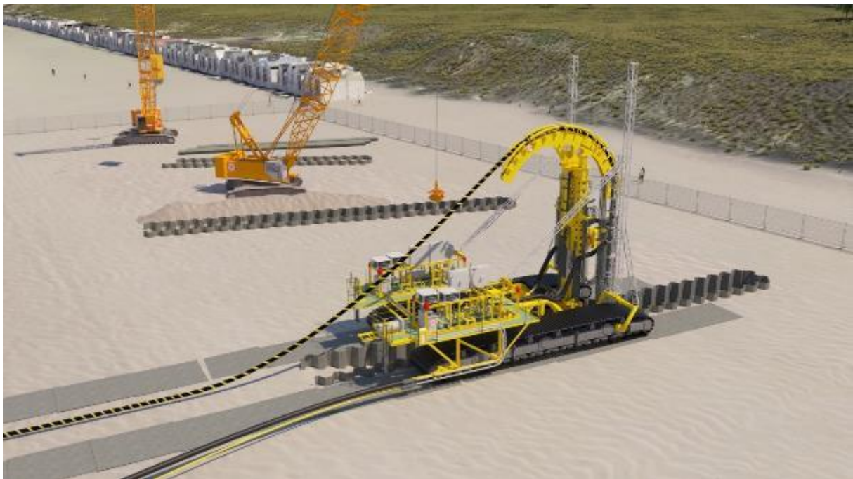
Figuur 3-2: Illustratie van begraafmachine (oud model) op strand met de kabel ingetrokken in de HDD
