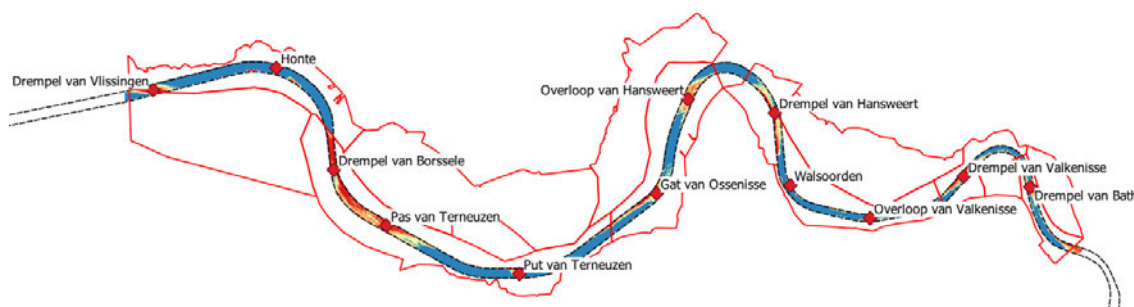
FIGUUR 12-1 BATHYMETRIE VAN DE HOOFDVAARGEUL IN DE WESTERSCHELDE (2017). DREMPELLOCATIES ZIJN GEBASEERD OP DEZE BATHYMETRIE EN ZIJN WEERGEGEVEN DOOR MIDDEL VAN EEN ROOD VIERKANT.
