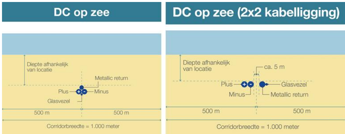
Figuur 2.2 Corridorbreedte van één kabeltracé op zee (met links de 1x4 kabelconfiguratie en rechts de 2x2 kabelconfiguratie)
