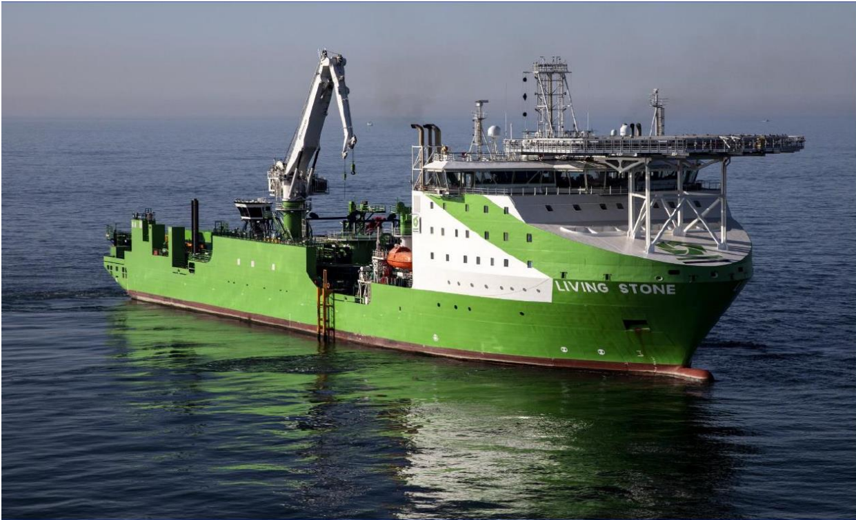
Figuur 4 Kabelschip Living Stone dat zal worden gebruikt voor de installatie van de kabel.
