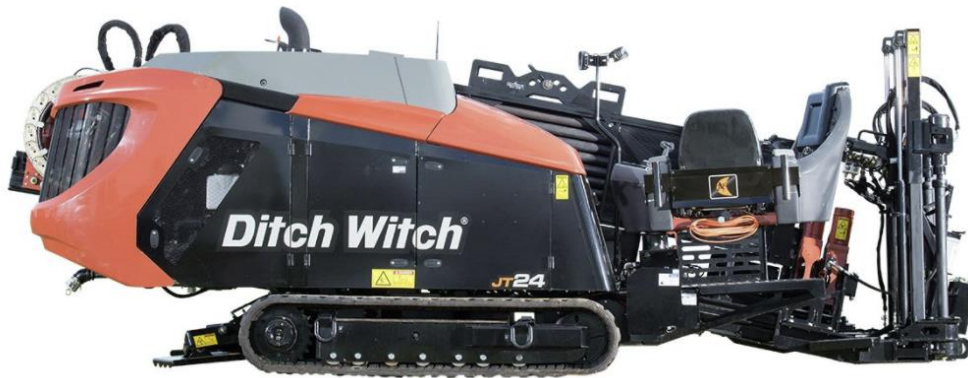
Figuur 11 Foto van een horizontale boorinstallatie zoals die gebruikt zal worden voor het boren van de aansluiting tussen strand en put.
