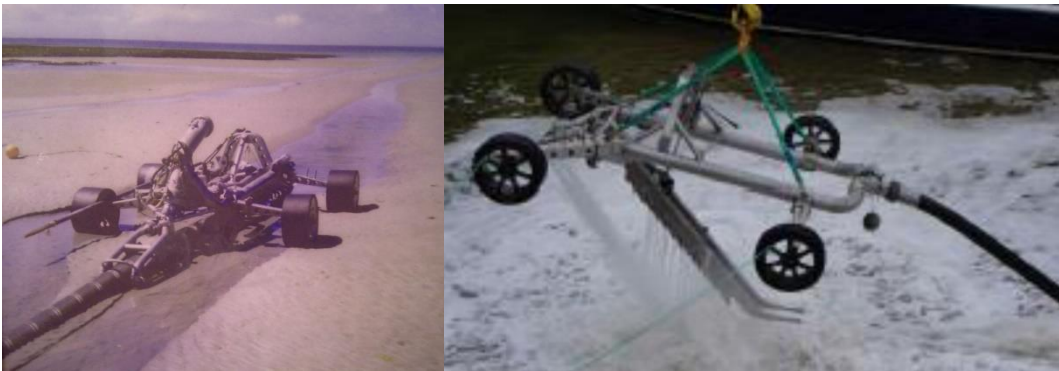
Figuur 10 Jet-trench gereedschap op wielen dat wordt gebruikt om de kabel in te graven tussen de laagwaterlijn en de CBT 1100.
