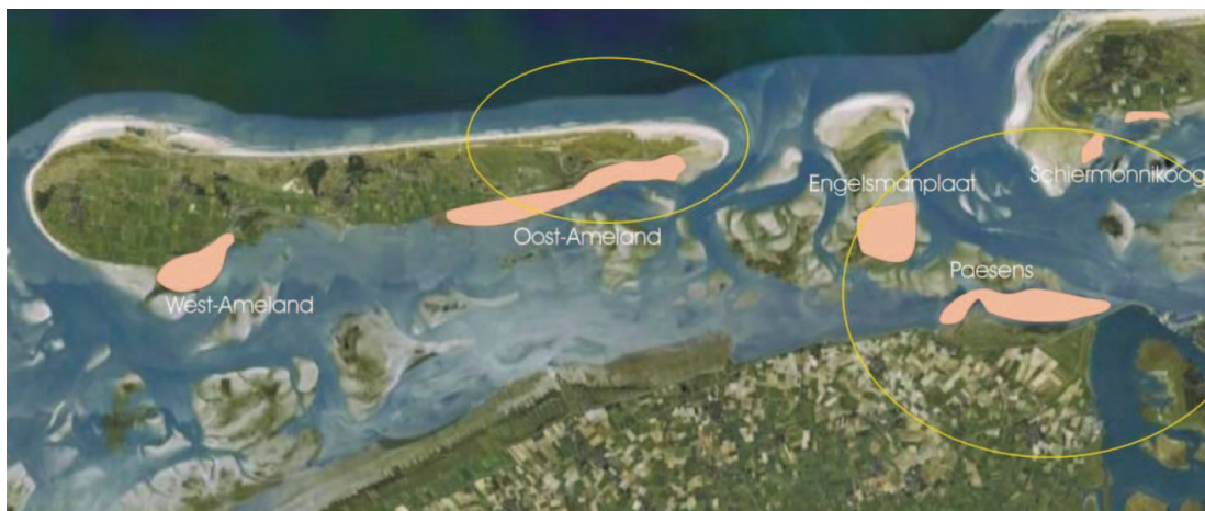
Figuur 6: locaties waar spijkermetingen worden uitgevoerd. De gele cirkels zijn indicatief voor de ligging van de bodemdalingcontouren (diepe bodemdaling). Ontleend uit Krol 2014 (ref. 10).
