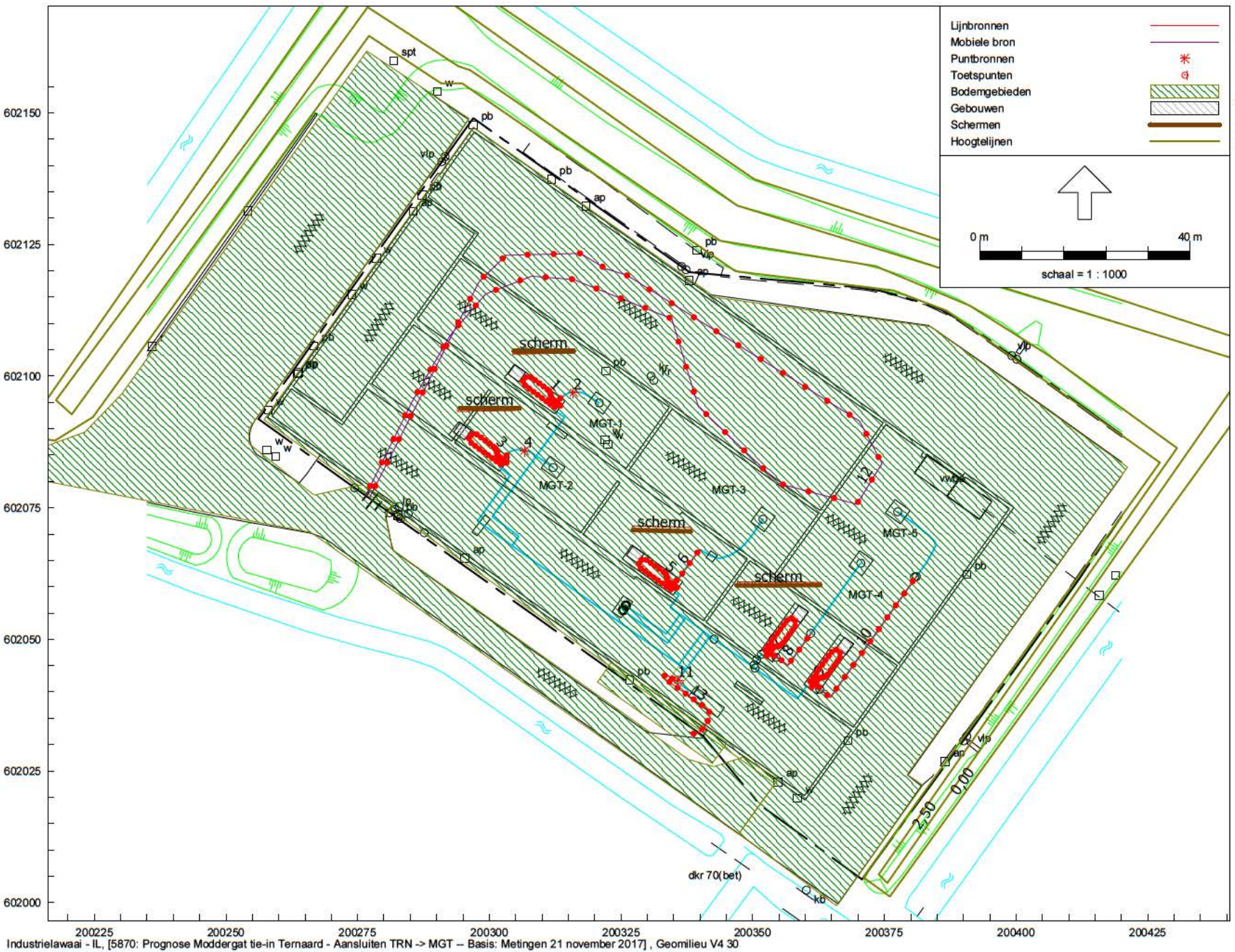
Industrielawaai - IL, [5870: Prognose Moddergat tie-in Ternaard - Aansluiten TRN -> MGT -- Basis: Metingen 21 november 2017], Geomilieu V4 30
