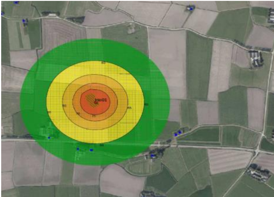
Figuur 5.12 Geluidscontouren heiwerkzaamheden in dagperiode op productielocatie (bron: MER Gaswinning en gasboring Ternaard)
