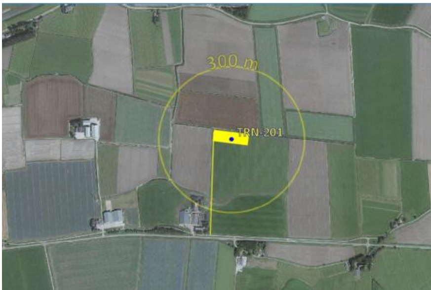
Figuur 5.13 Geluidscontouren etmaalwaarde booractiviteiten op productielocatie (Bron: geluidprognose putboring T-700, LBP Sight)
