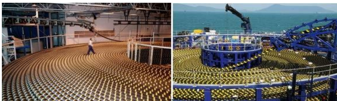
Figuur 4-26: Typische draaitableaus in de fabriek en op het schip
