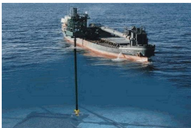
Figuur 4-27: Schip met valpijp
