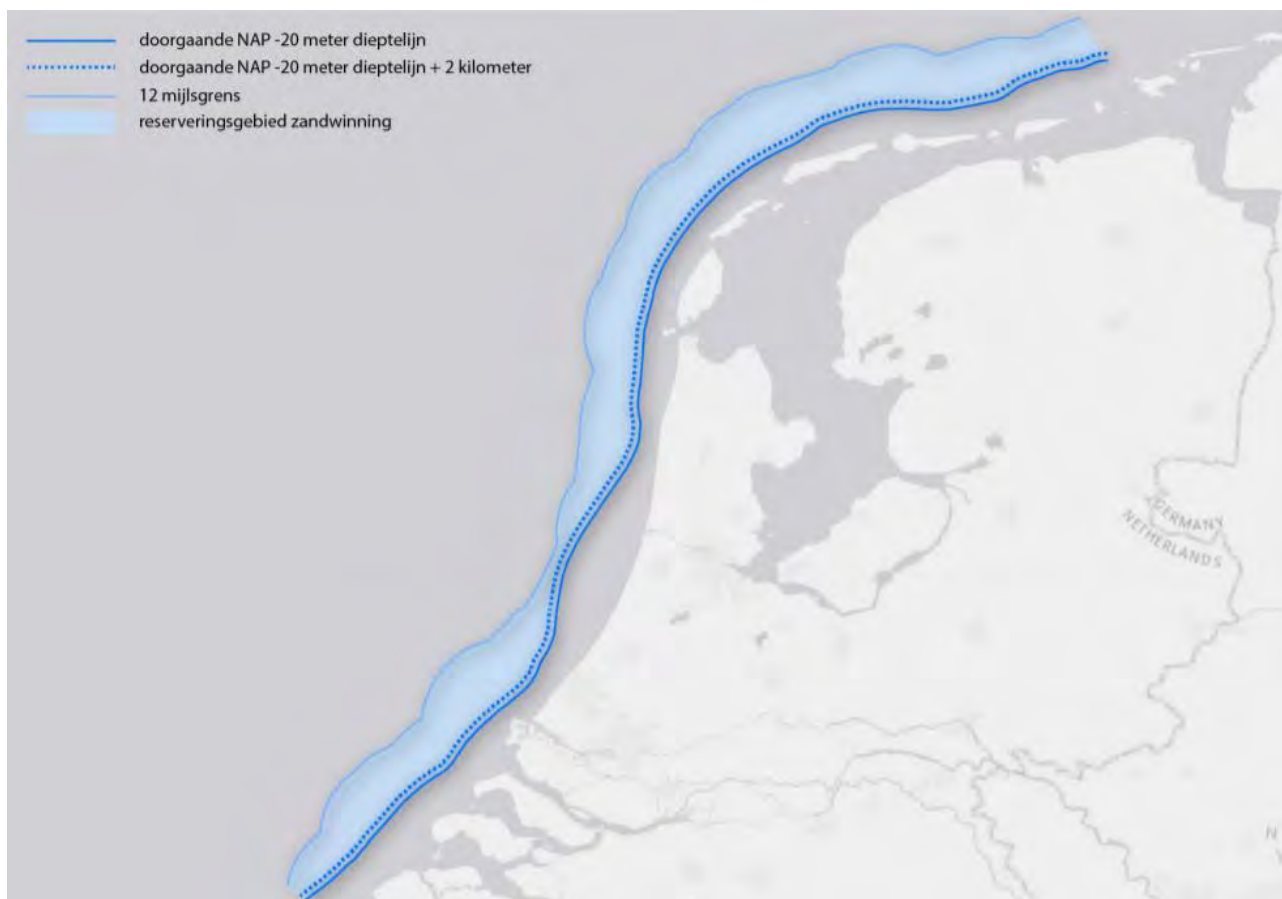
Figuur 8.7 Het reserveringsgebied voor zandwinning op de Noordzee tussen de doorgaande NAP -20 m dieptelijn en de 12-mijlsgrens. Bron: MER Winning ophoogzand Noordzee 2018 t/m 2027
