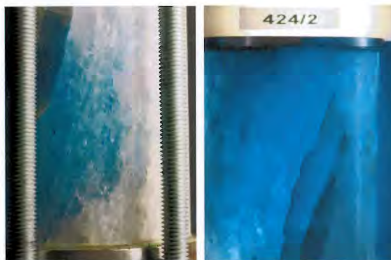
Abb. 8: Markierte Fließwege entlang der Korngrenzen im hochdruckseitigen Prüfkörperbereich
