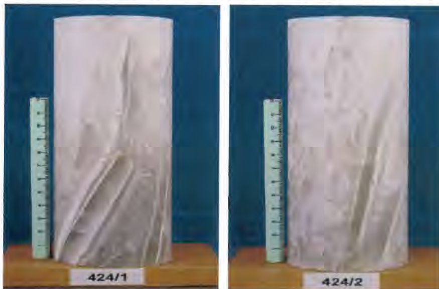
Abb. 2: Prüfkörper für Gasdurchströmungstests
