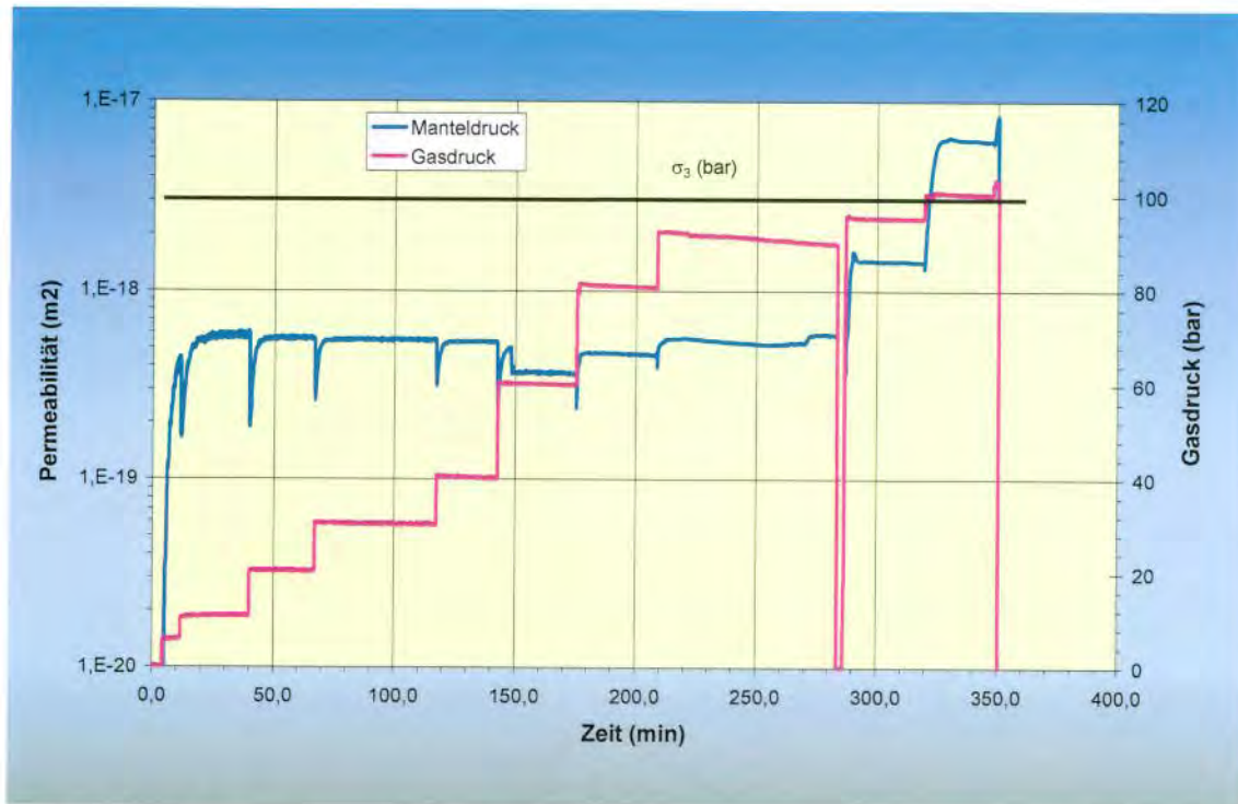
Abb. 5.: Darstellung der Gasdruckbelastung im Permeationsversuch 424/1
