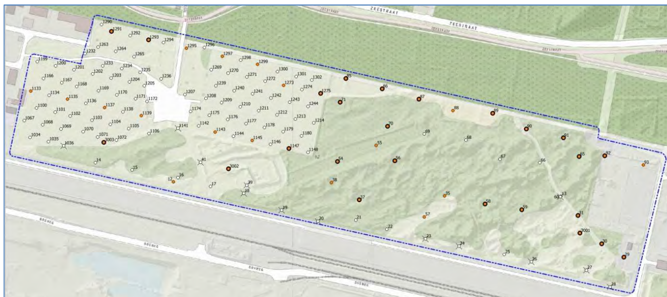
Figuur 9. Deelgebied 8 Transformatorstation (Tata Steel): de dieper doorgezette boringen (oranje), de getuiste boringen (kruis) en de boringen met een humeuze laag (zwart).
