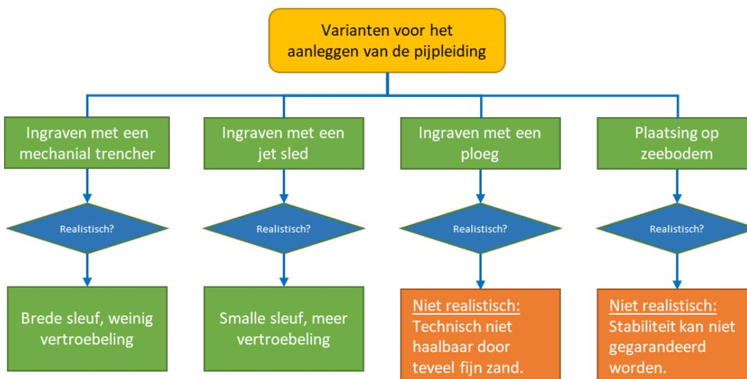
Abbildung 21: Varianten für die Verlegemethode der Rohrleitung
