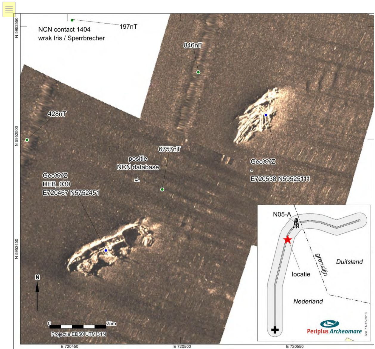
Abbildung 20: Seitensichtsonarbild des Wracks der Iris/Sperbrecher (NCN1404, 1942).
