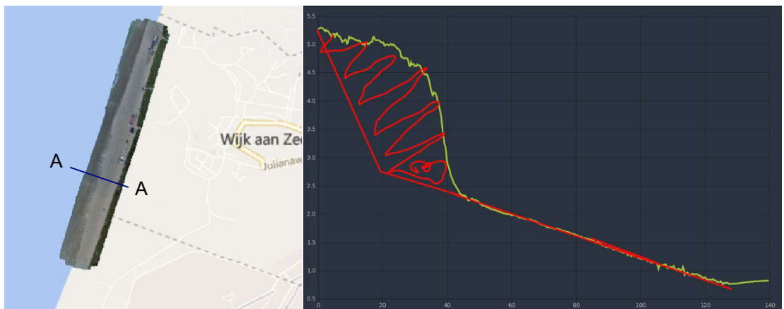
Figuur 1-1: Links: drone meting van de locatie van de beoogde zandontgraving. Rechts: strandprofiel voor (groen) en schets van het beoogde profiel (rood) na de zandontgraving langs dwarsprofiel AA.
