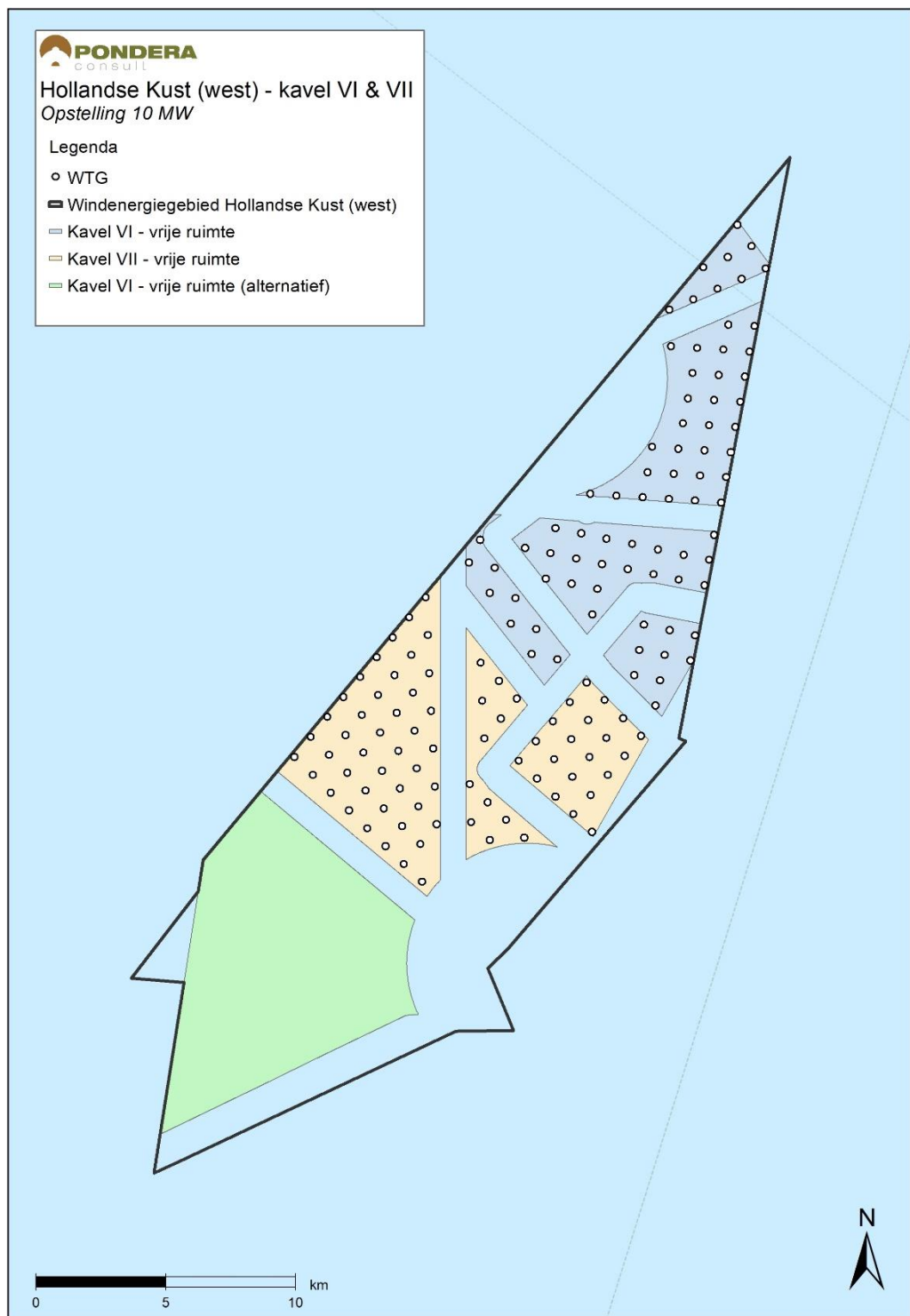
Figuur 2.2 Opstelling met 76 turbines van 10 MW in kavel VI (voorkeursligging) en in kavel VII
