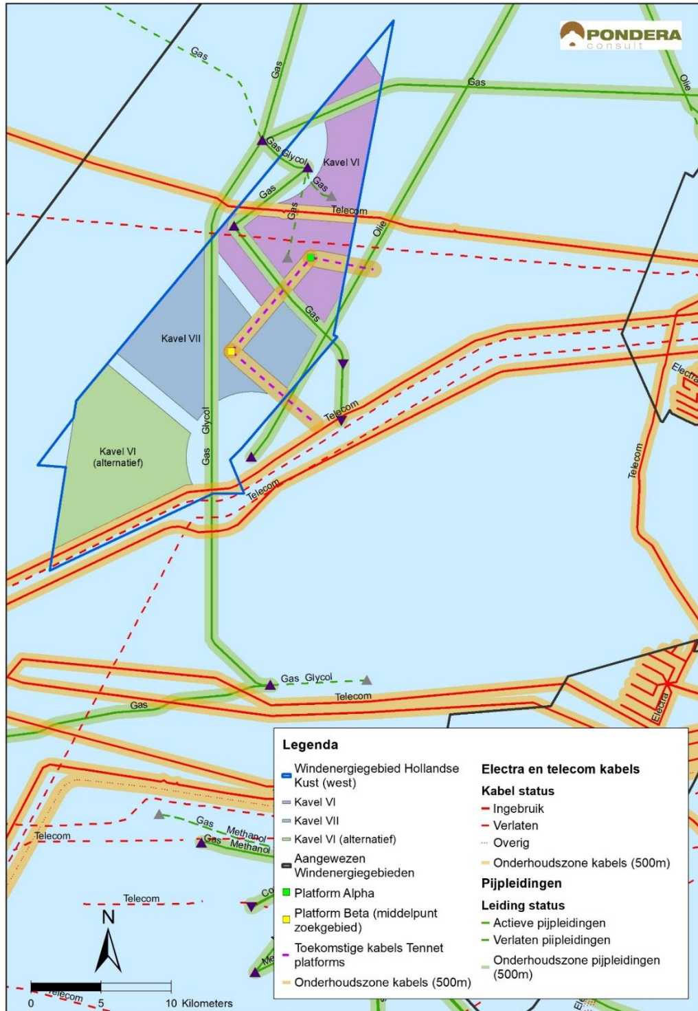
Figuur 10.19 Ligging kabels en leidingen in omgeving Hollandse Kust (west)
