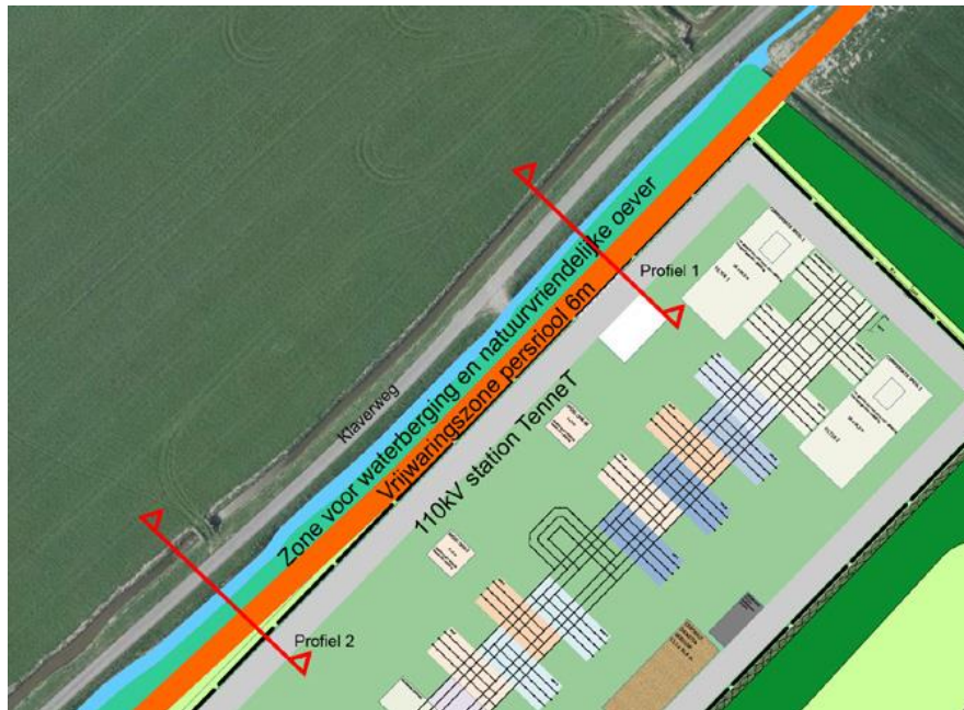
Afbeelding 5.7 Verbreding watergang en aanleg natuurvriendelijke oever
