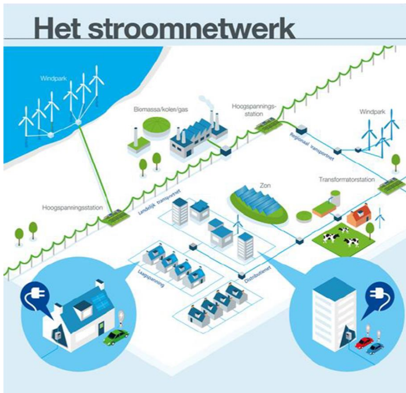
Afbeelding 1.4 Schematische weergave van het stroomnetwerk (bron: TenneT)
