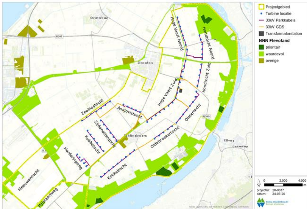
Figuur 2.2. Overzicht van de aan te leggen bekabelingen en trafostation (de turbines en het NNN zijn tevens aangegeven)
